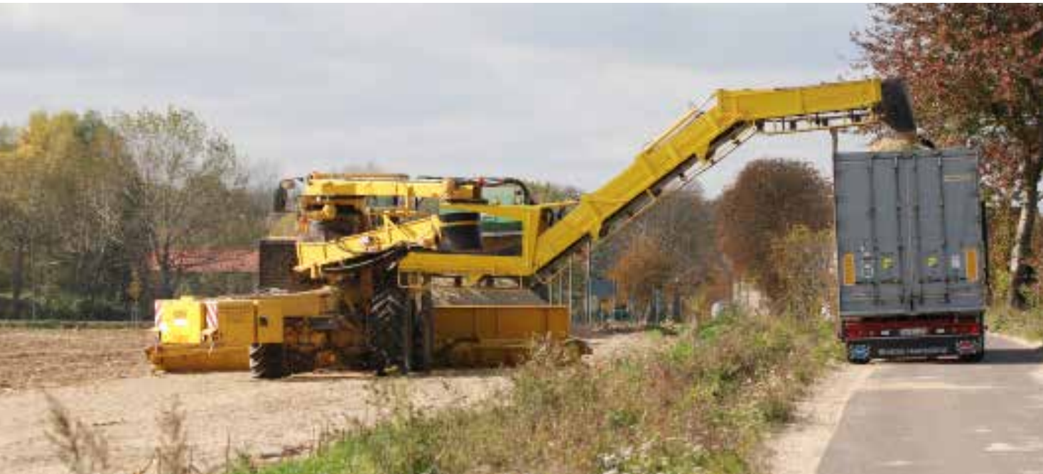
Der schwenkbare Überladearm reicht bis zu 13 m weit und überbrückt problemlos Gräben, Feldraine und Hecken.
