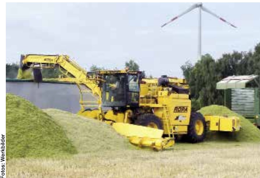
Der Mietenplatz lässt sich mehrfach nutzen. Die Abfahrer können gleich hinter der Maus wieder abladen. Ist die Maus vorne angekommen, fängt sie hinten wieder an.
