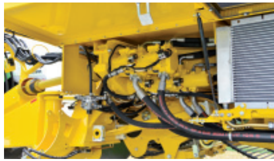
Die Bordhydraulik wird mit der Zapfwelle angetrieben und sitzt links unter dem Bunker.
