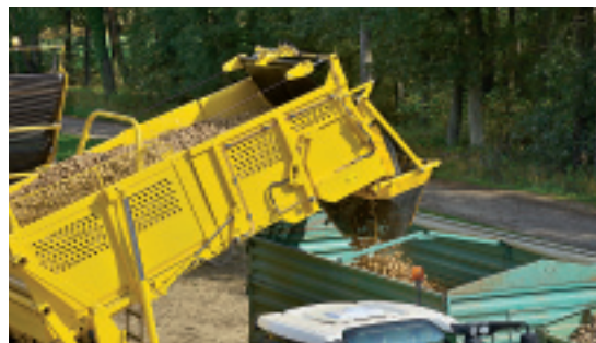
Zum Überladen lässt sich der Bunker auf 4,20 m anheben.
