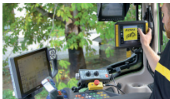
Die Maschine wird über ein ISOBUS-Terminal und eine Bedienbox gesteuert.
