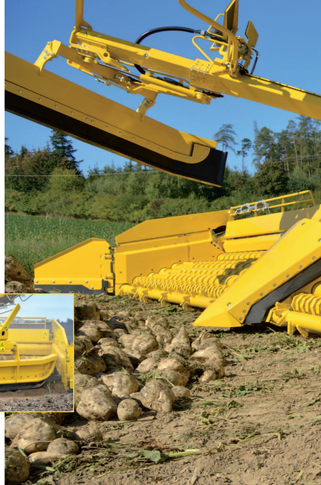
Мощный пропорционально управляемый подборщик остатков свеклы с изогнутыми углами
