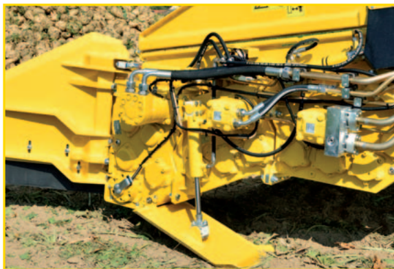
Separat drev til de 3 valsegrupper med individuel justering af omdrejningstallet og automatisk reversering ved fastklemte sten.
