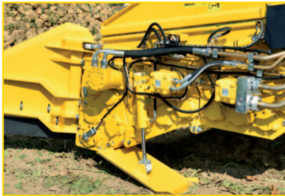
Separate Antriebe für 3 Walzengruppen mit individueller Drehzahlanpassung und automatischer Reversierung bei Steinklemmer
