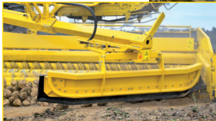
Robustní dočišťovač ukládky se zahnutými rohy, proporcionálně ovládaný
