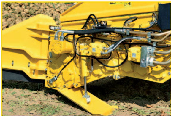
Samostatné pohony pro 3 skupiny válců s individuálním nastavením rychlosti a automatickou reverzací při zaklínění kamenů
