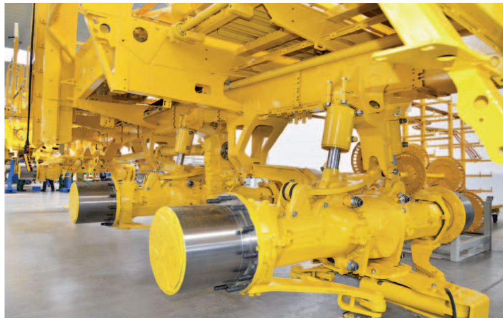
Châssis hydraulique, mise à niveau en dévers automatique
