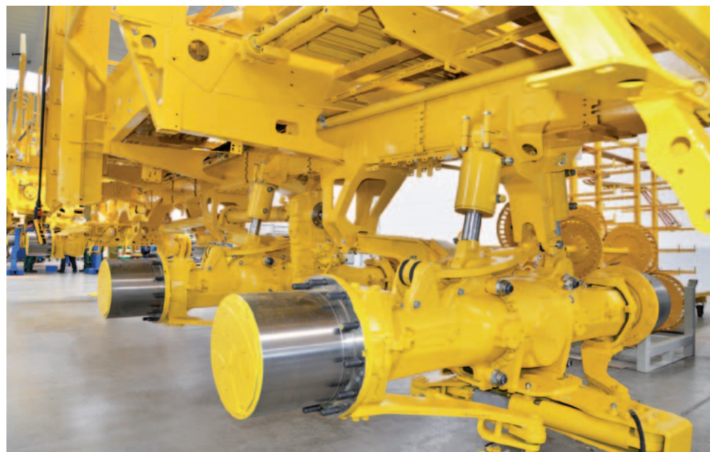
Hydraulisk akselsystem, automatisk hældningsudligning
