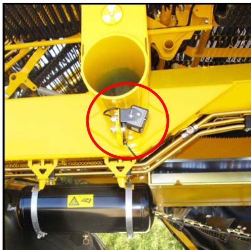
污物排卸带摄像机
