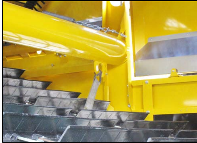
右侧机器固定点
