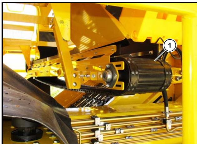
(1) 混合垃圾排卸带
