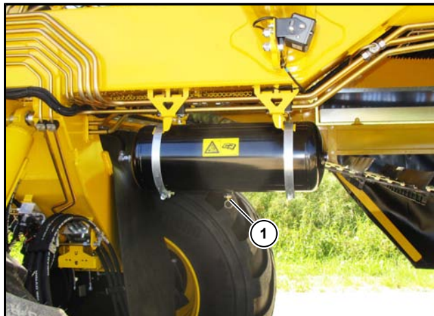
(1) 带排放阀的压缩空气罐
