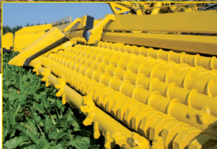
3个辊筒组各自独立的驱动装置支持转速单独调节及石块卡塞时自动倒转。
