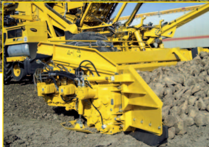
3个辊筒组各自独立的驱动装置支持转速单独调节及石块卡塞时自动倒转。
