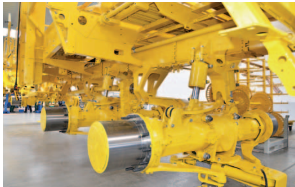
液压行走机构，自动斜坡补偿
