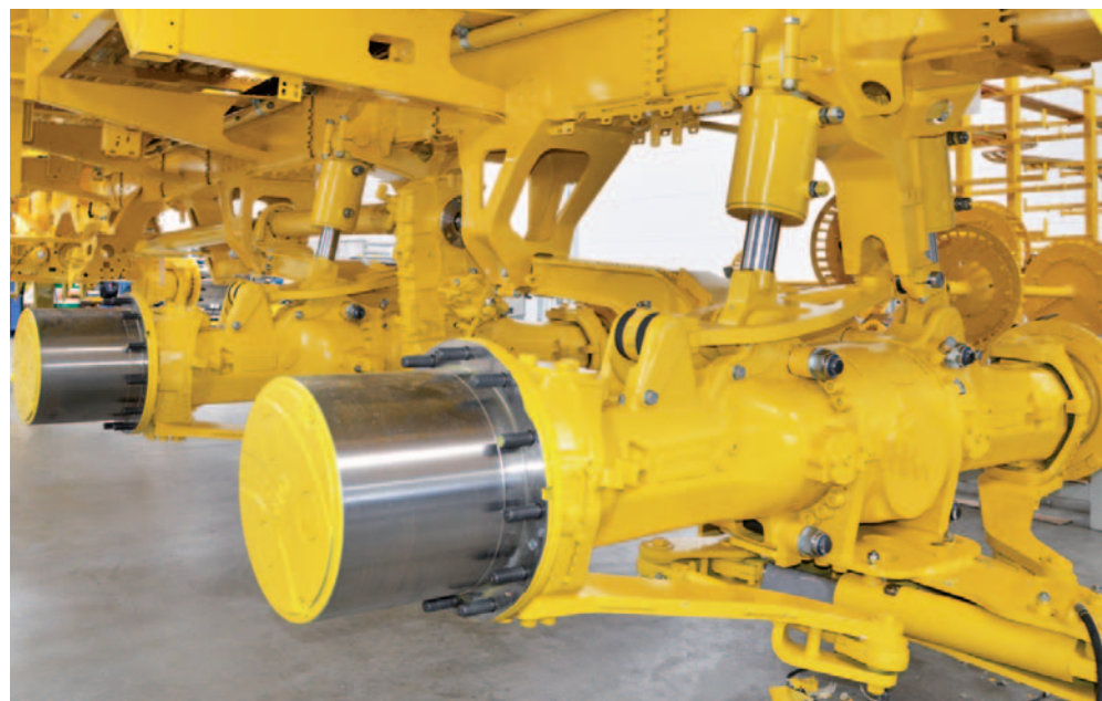
Carrello idraulico, compensazione pendio automatica
