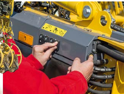
Per Taster am Rodeaggregate kann auch der Motor gestartet und abgestellt werden.
