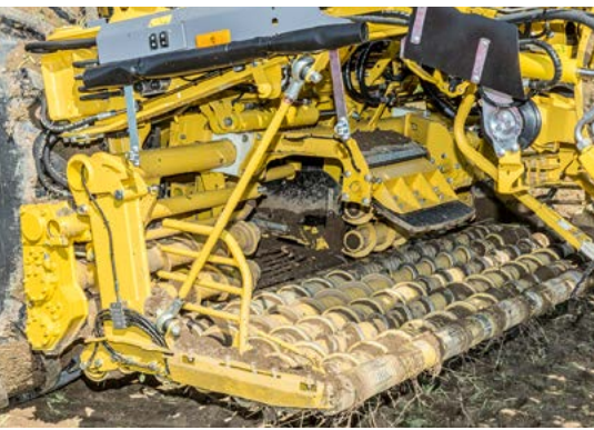
Der neue Walzentisch verfügt über sieben lange Reinigungswalzen.
