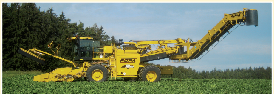
标准机械式手臂;最大远距伸展总长11.5公尺
