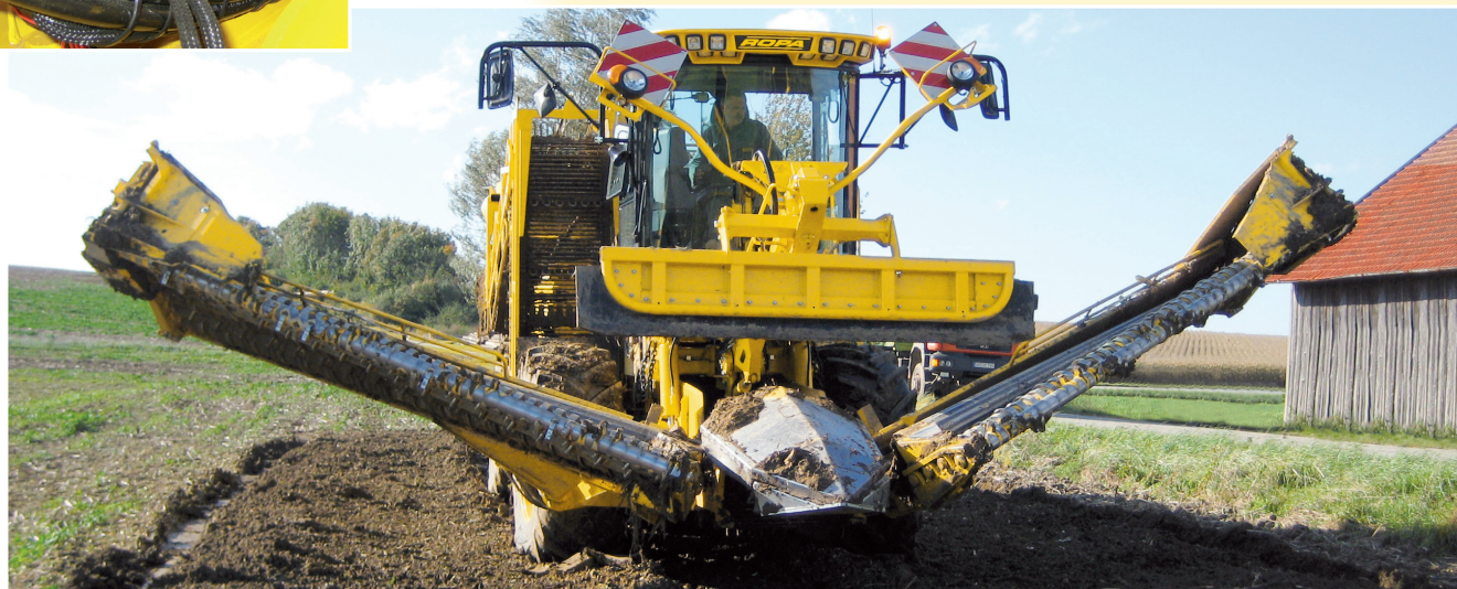
两分钟内由农业机作业模式迅速变更为一般路面行驶模式 - 可在驾控室内操作完成
