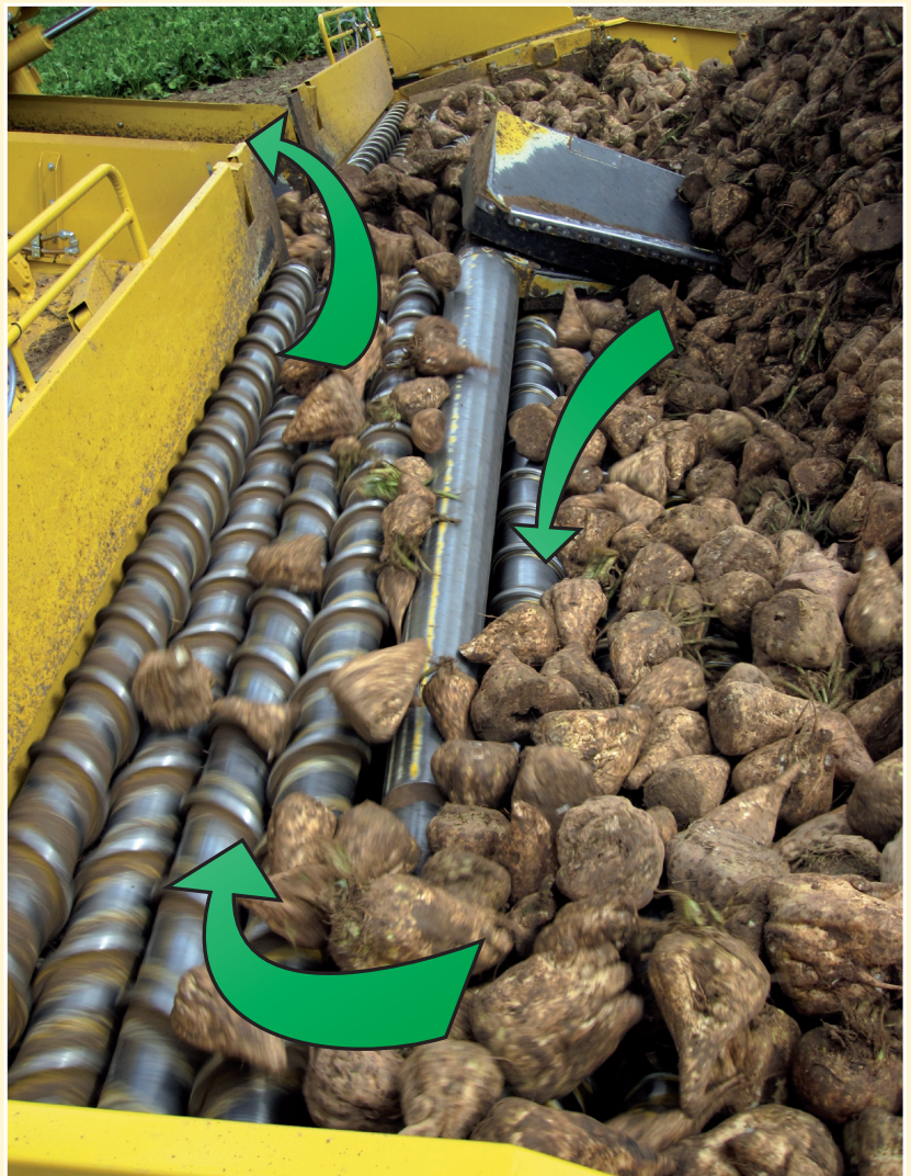
左右双道清理设计 --- 圆锥滚筒区隔块根动线
