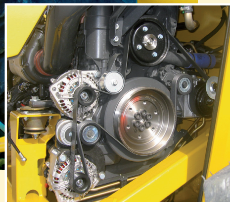
坚固持久的平面带传动装置
