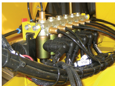
驱动装置 - 电子控制气压换挡
