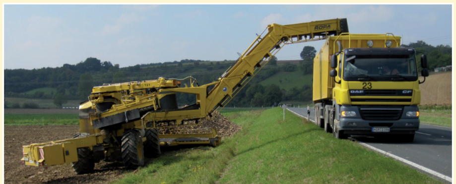
标准机械式手臂;最大远距伸展总长11.5公尺
