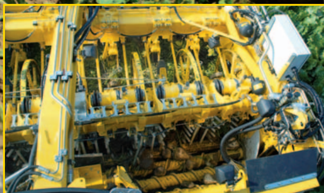
Fri sikt ner i bordet -> föraren kan se raderne och resultatet av Micro-Topping
