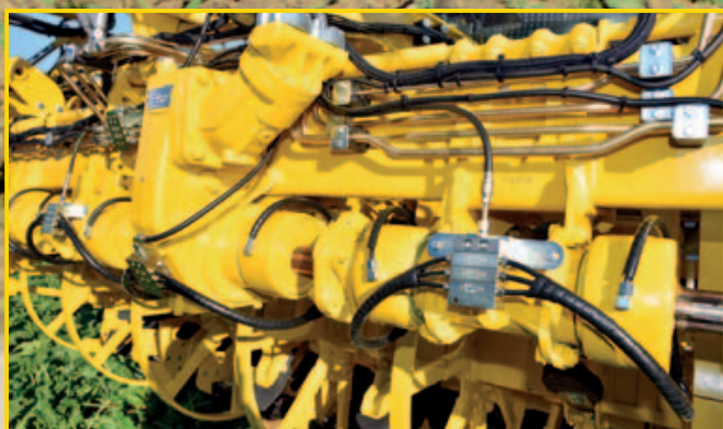
Skärdrivning med kugghjul och justerbara rulllager och axial kolvmotor
