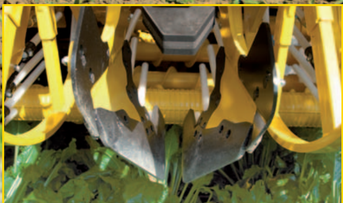
ROPA skär. Skärvinkel- och avstånd kan inställas i 6 positioner, för bästa möjliga skydd av betorna
