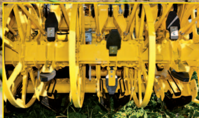
Djuphållningshjul och variabel radavstånd 45(48)/50 cm, kan levereras med hydraulisk inställning
