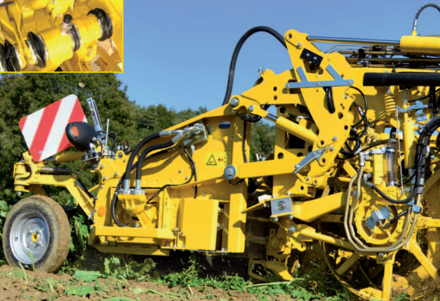
Hydrauliskt stenskydd, med underhålsfri högt monterat linjär drivning
