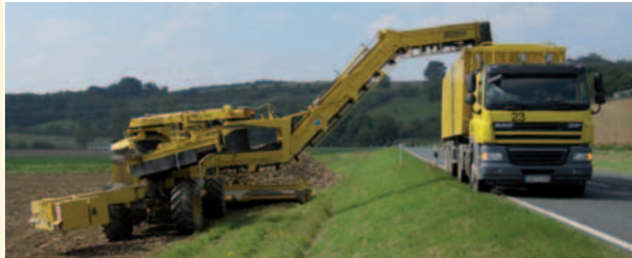
Uzatmalı yükleme bandı ile 13 m yükleme menzili
