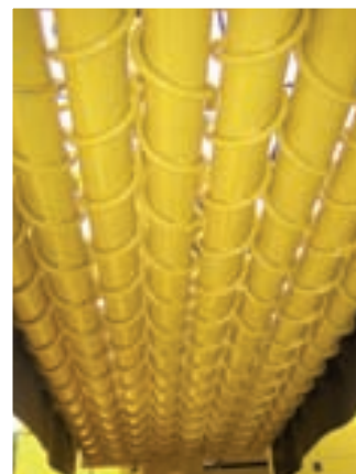
Čistač s valjcima s podesivom kočnicom za repu
