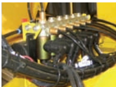
Mjenjač – elektropneumatsko prebacivanje brzina
