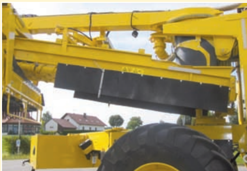
Okretnica s kugličnim ležajem promjera 1200 mm – zakretni dieselski spremnik
