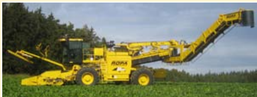
Standardni transporter, 11,5 m doseg utovara
