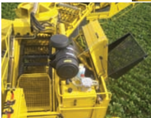
Rasklopna stražnja strana trake ispod kabine
