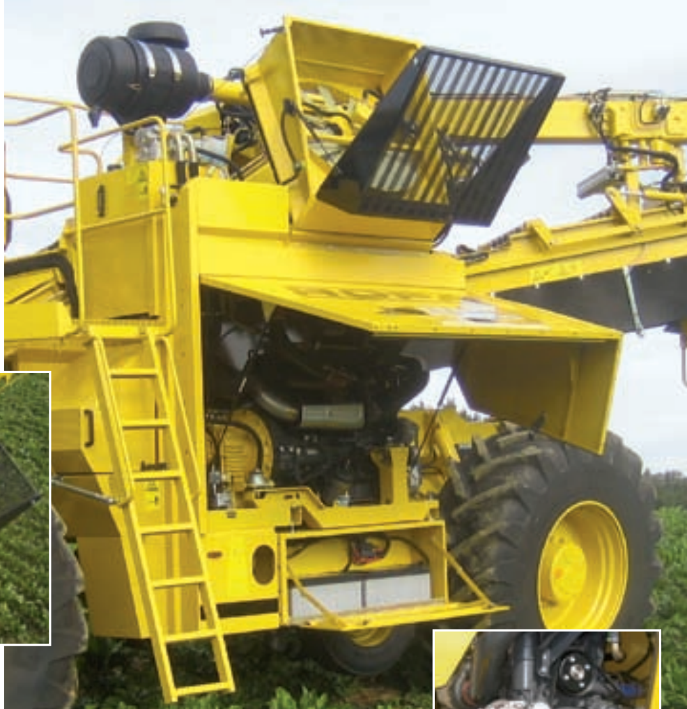
Rasklopna stražnja strana trake ispod kabine
