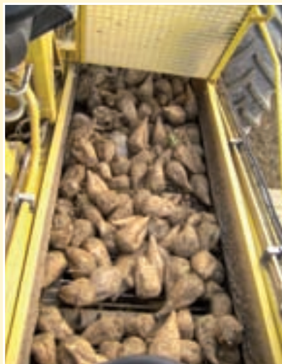
Traka ispod kabine s izdržljivim PU-skupljačima
