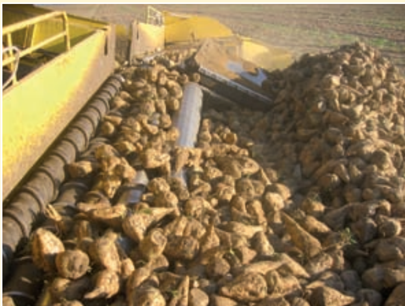
Dvostruki put čišćenja – stožasti valjak dijeli tok repe
