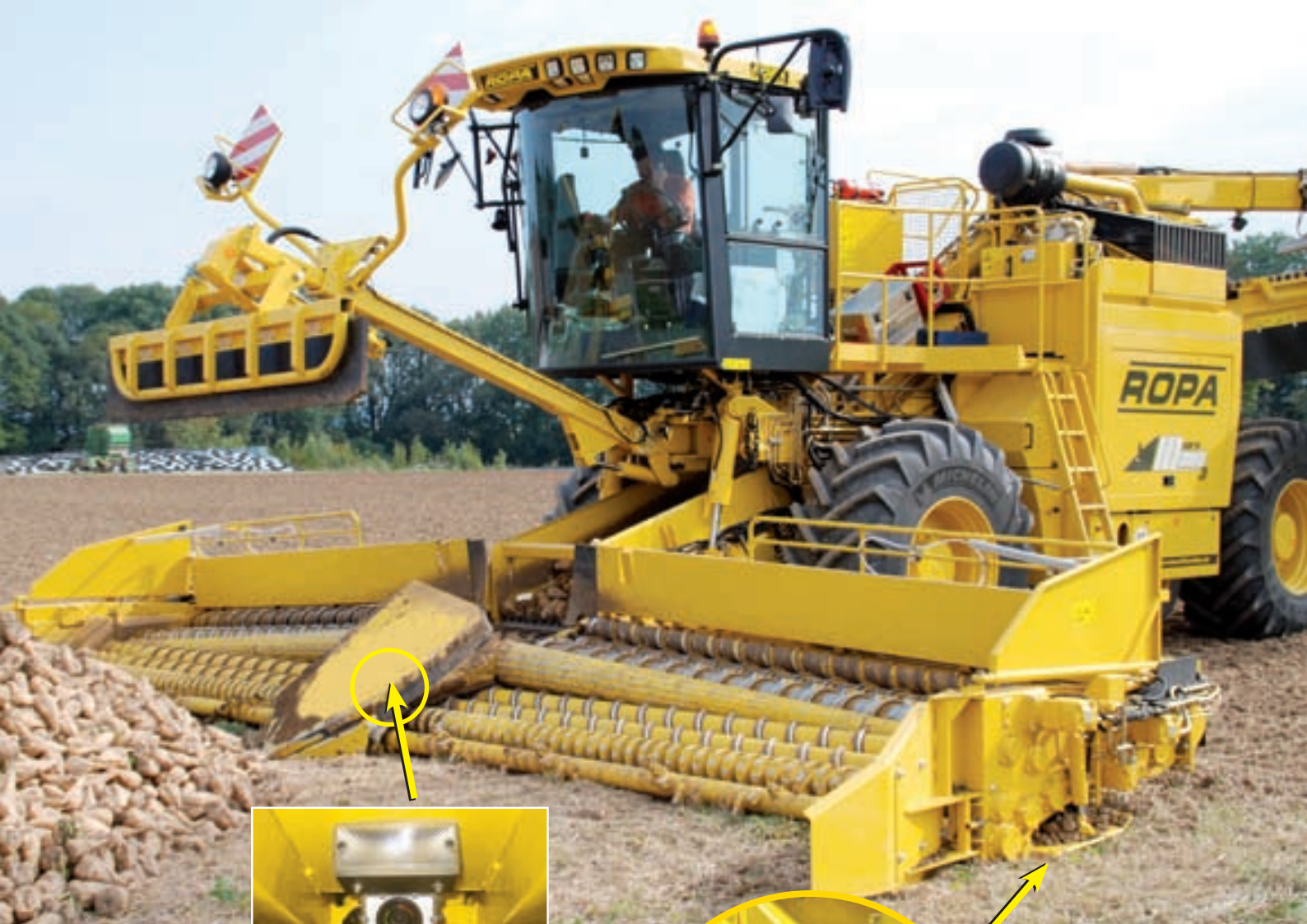
Video sistem u boji za dubinsko vođenje ispod srednjeg vrha
