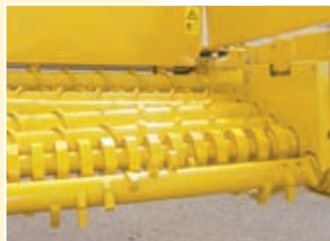
Izmjenjivi prsti prihvaća, PU-prsti sakupljača za nježno čišćenje
