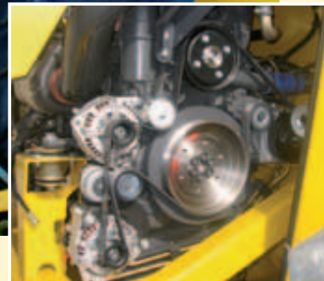
Погон с равним каишем једноставног одржавања
