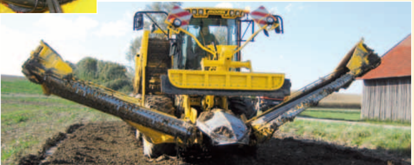
Трансформација из транспортног у радни режим за мање од 2 минута – без силажења возача
