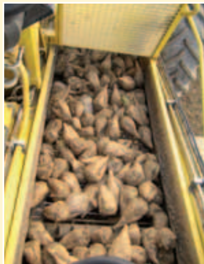
Улазна трака за чишћење са полиуретанским носачима репе
