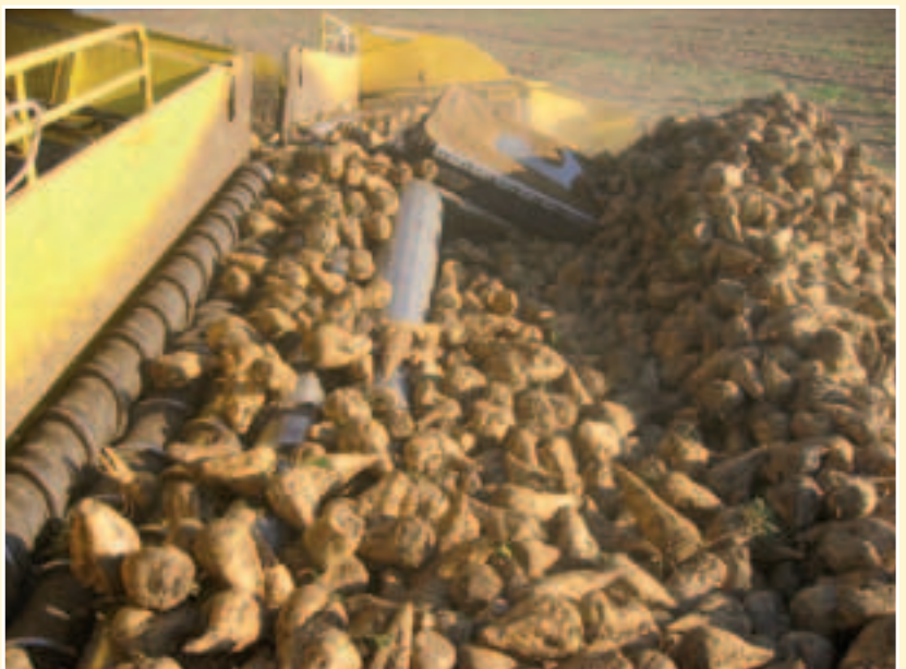
Двоструки пут чишћења – конусни ваљак дели ток репе
