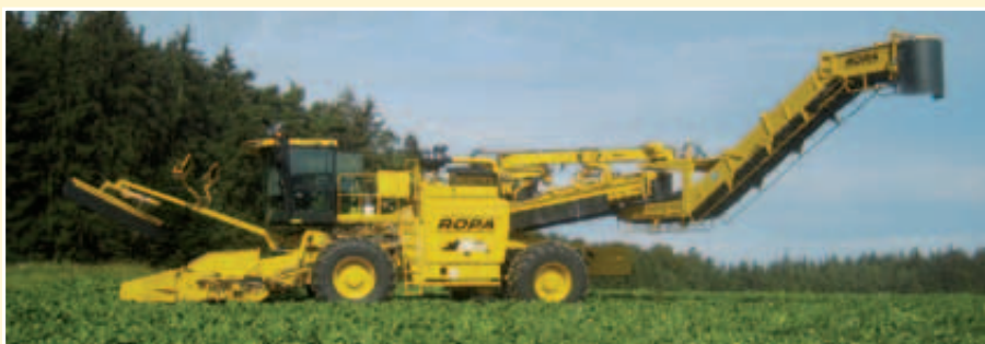
Standardowa wersja wysięgnika, zasięg: 11,5 m
