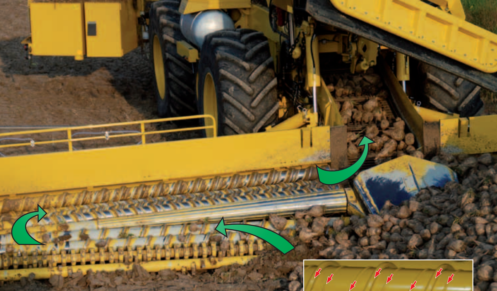
Podwójna droga czyszczenia- walec stożkowy dzieli strumień buraków
