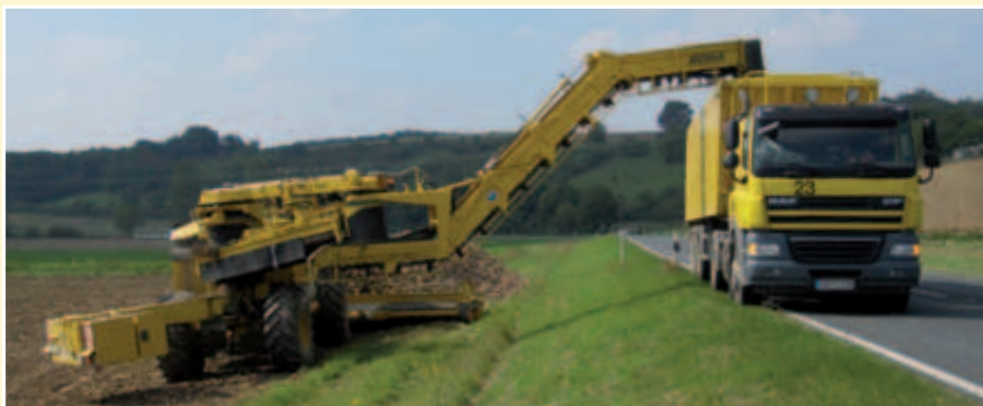
przedłużony wysięgnik – zasięg 13m
