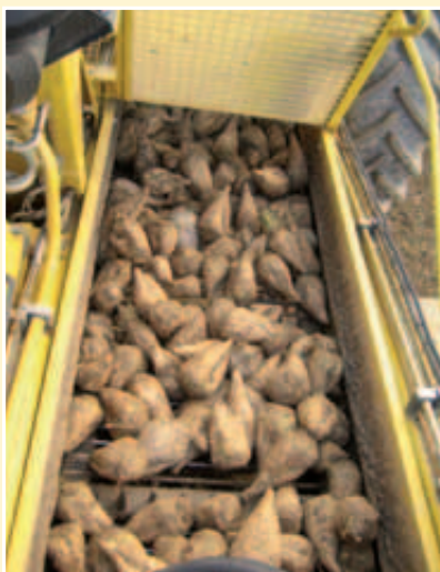
Pas dennej z wytrzymałymi palcami zbierakowymi-PU
