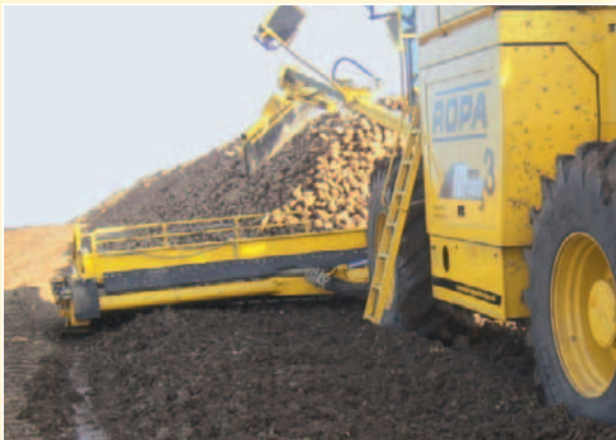
Intensywne oczyszczenie buraków z pozostałości ziemi, resztek liści i główek
