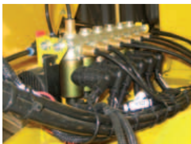
Skrzynia biegów- elektryczno- pneumatyczna przekładnia biegów
