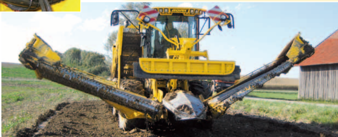
Przystosowanie maszyny do jazdy po drodze w czasie krótszym niż 2 min- bez wysiadania operatora z kabiny
