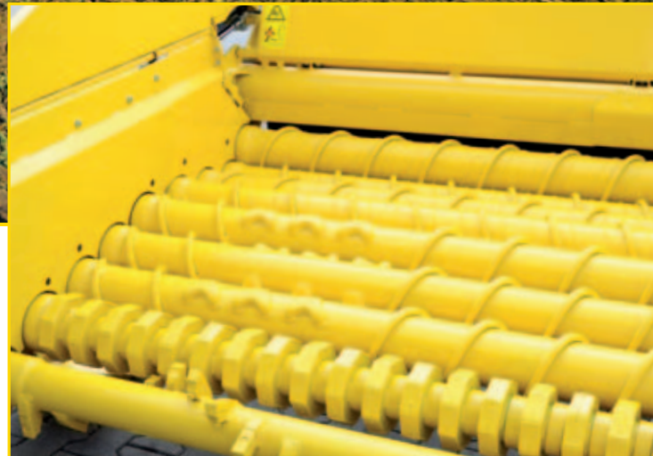
Za 3 grupe valjaka se koristi odvojen pogon sa nezavisnim podešavanjem broja obrtaja i automatskim reverzerom u slučaju zaglavlivanja.
