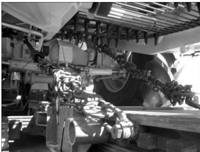
Verzurrung der Vorderachse mit Spannketten
