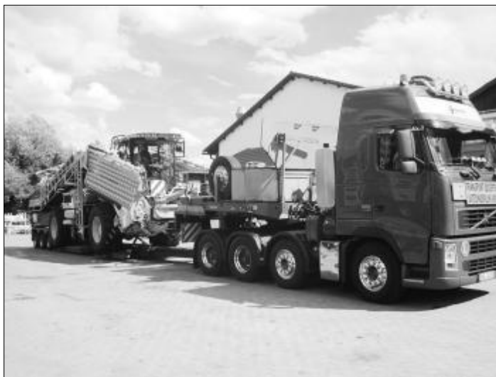
Ordentlicher Tieflader für Straßentransport mit Minimaltransporthöhe
