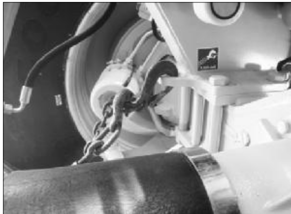
Verzurrpunkt hinter der Vorderachse links
