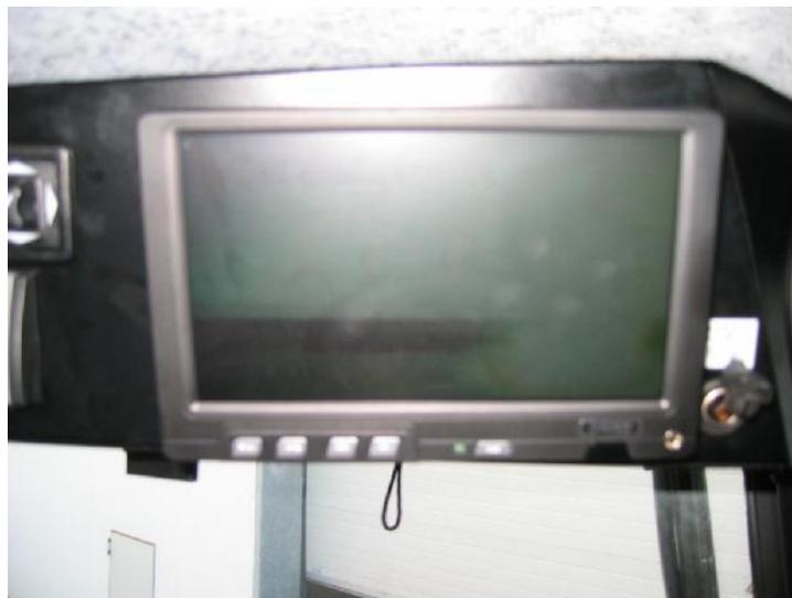
按下控制台上标有摄影机标识的开关，可在最多三个摄影机的画面间进行切换。
