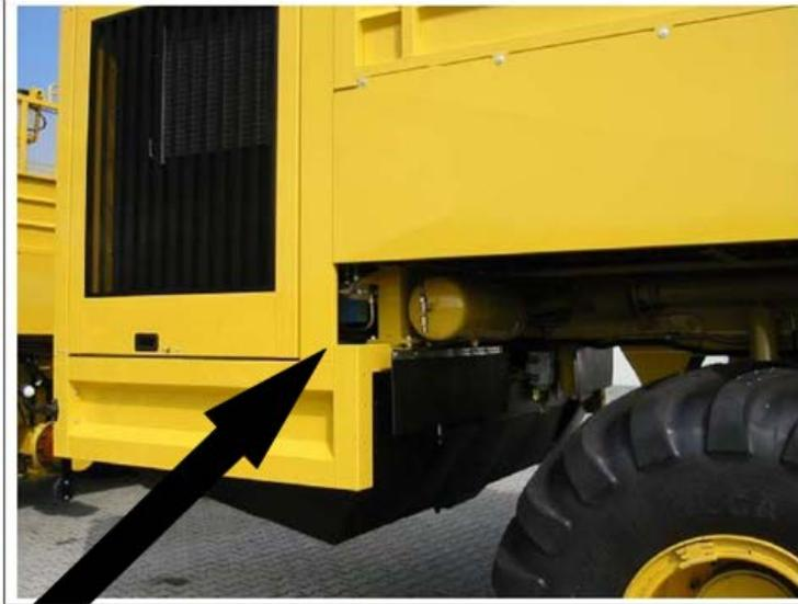
将电池开关向上拉至水平，就能将机器的电力打开
