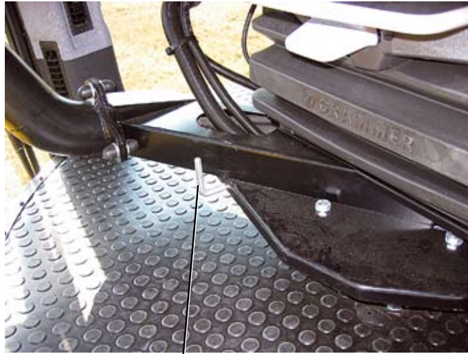
Yol sürüşü için mekanik koltuk kilidi
