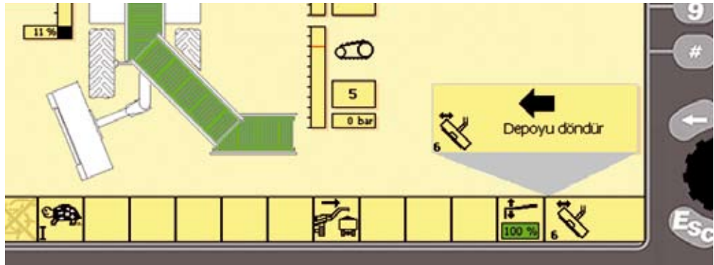
Yakıt deposu daima, seçilen yükleme yönünün aksi yönünü göstermelidir.
