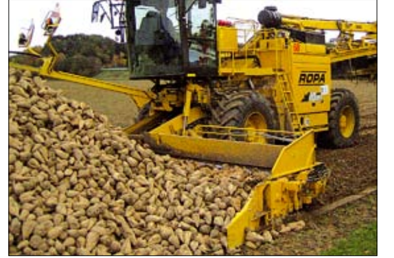
İzin verilen maksimum mahsul genişliğinin aşılması halinde pancar kayıpları
