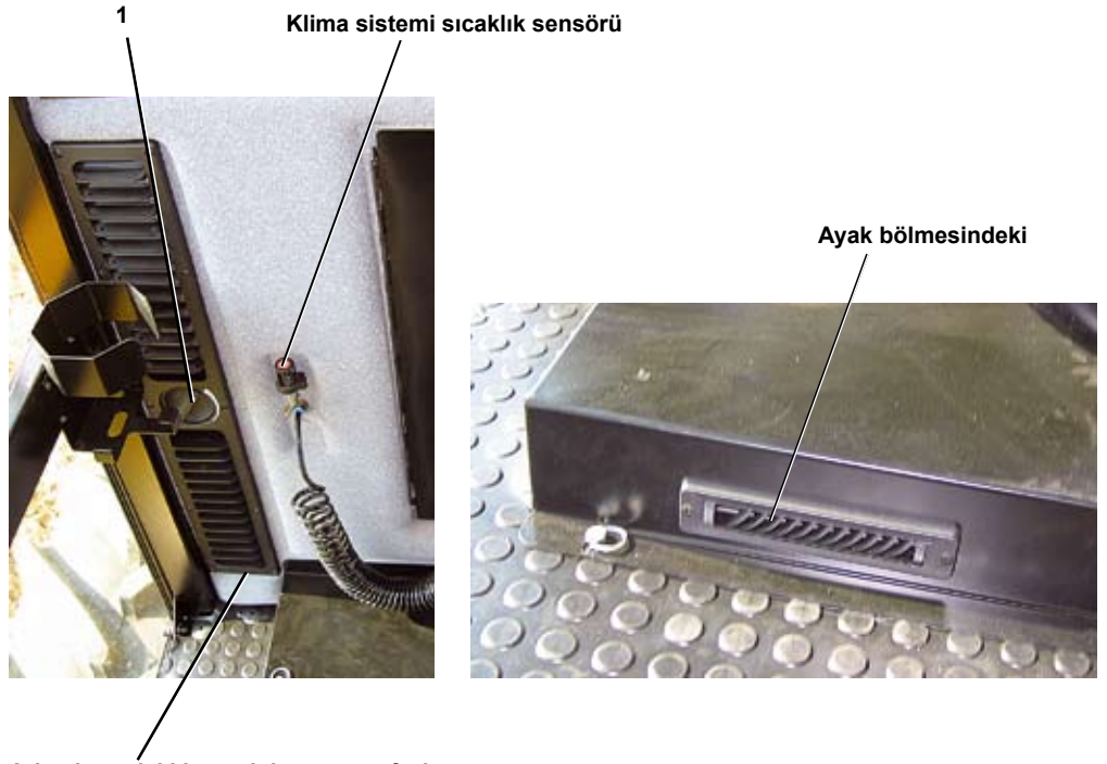
Arka duvardaki hava dolaşımı menfezi
