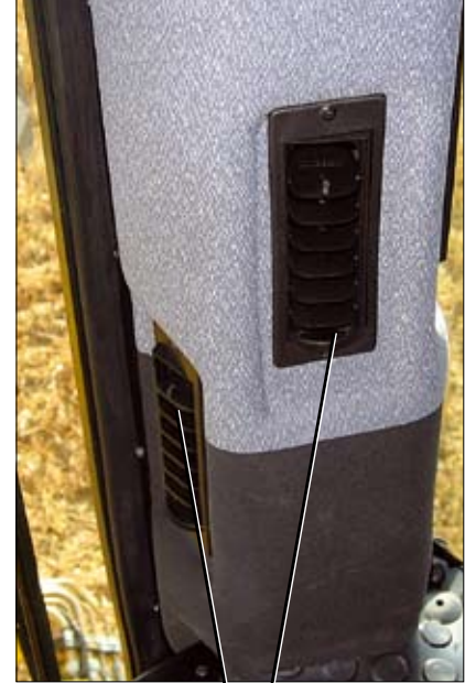
Örnek olarak: Sürücü kabininin sağ A-kolonundaki hava menfezleri
