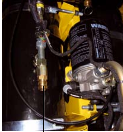
Arkadaki basınçlı hava deposundaki basınçlı hava raketu (sadece su püskürtme sistemi olmayan versiyonda)
