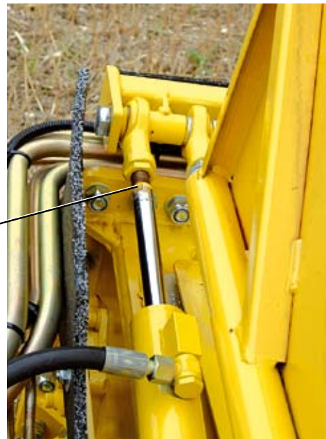
Klape sacı silindirindeki olması gereken kırılma yeri
