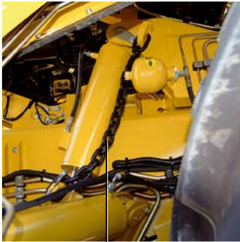
Emniyet zinciri toplayıcının orta parçasına takılmış halde
