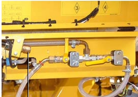
Su püskürtme sistemindeki basınçlı hava raketu
