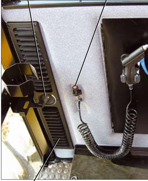
Arka duvardaki hava dolaşımı menfezi
