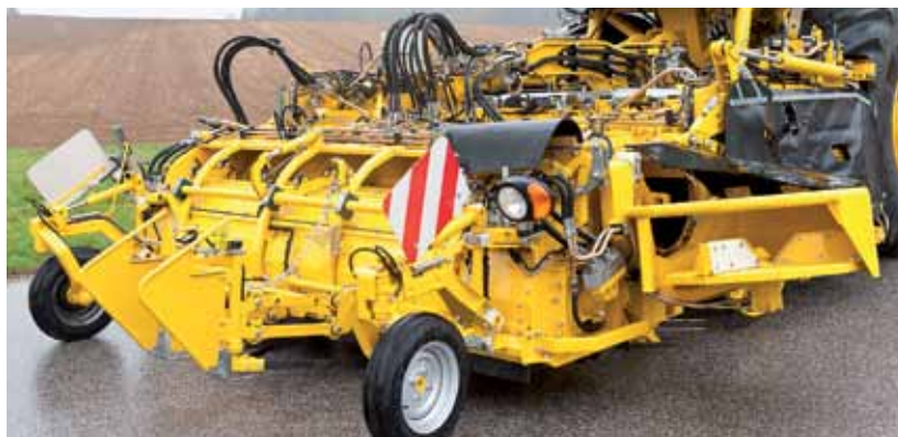
PASWh-blastare, blasterlucka nere
