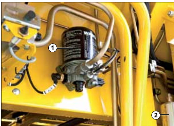
(1) Lufttorkare (2) Tryckluftsbehållare för regenerering lufttorkare
