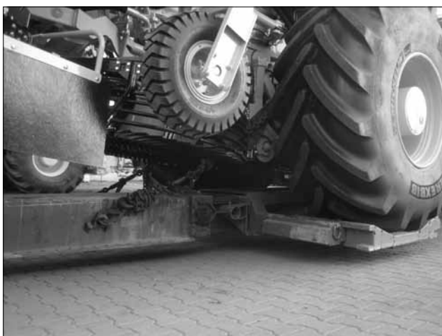
Surrning av framaxeln på trailern med spännkedjor
