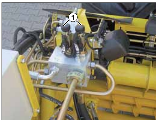
(1) Handrattar nödinställning Djuphållningshjulets varvtal (ej vid XL)
