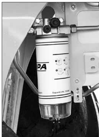
Standardmässigt förfilter med kolvump
