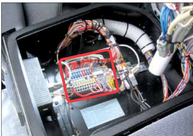
Säkringar (F40 till F48) i stolskonsolen.
