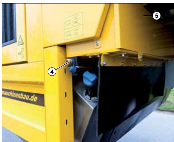
(4) Tryckluftskoppling på utsidan av batterilådan
