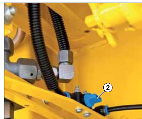
I den visade positionen är avstängningskranen (2) öppen. Vrid 90° för att stänga.
