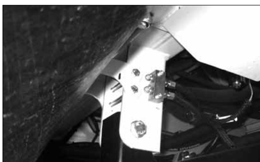
Nippelblock på den bakre vänstra tankvridpunkten.
