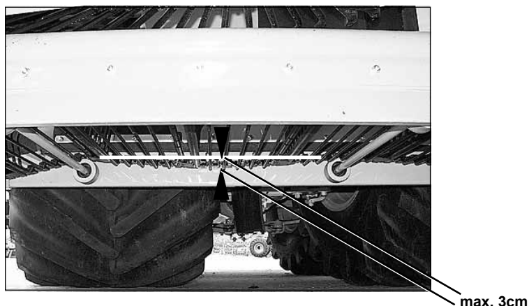
Elevatorrem korrekt spänd.
