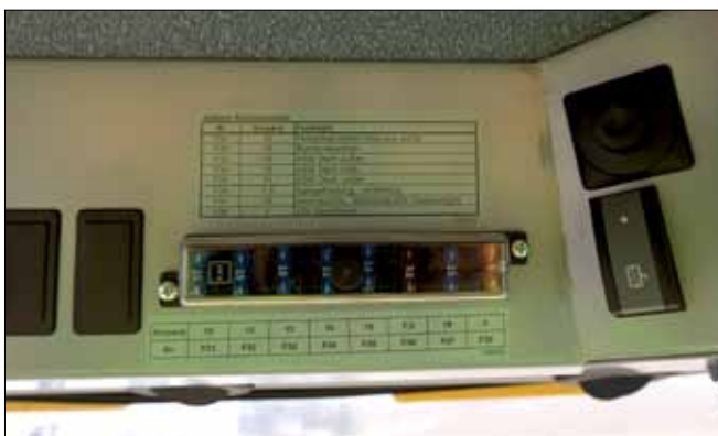
Säkringar (F31 till F38) i radiokonsolen
