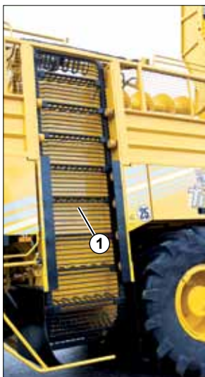
(1) Ringelevator (2) Drivningshjul höger bak
