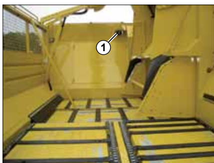
(1) Ultraljudssensor i tankens bakvägg.
