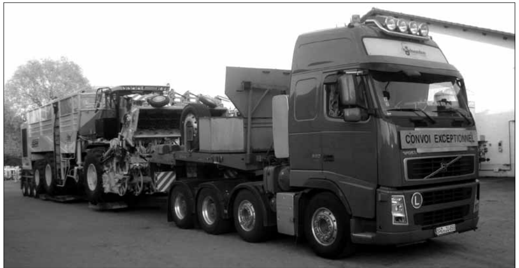
Korrekt utrustad trailer för vägtransport med minimal transporthöjd
