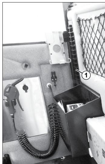
Luftcirkulationsgaller i bakväggen
