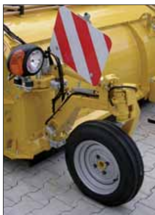
Sensorhjul i upptagningsposition
