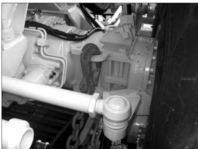
Surrningsögla på framaxeln till höger (bak)
