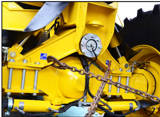
Punkty mocowania na koźle osi tylnej
