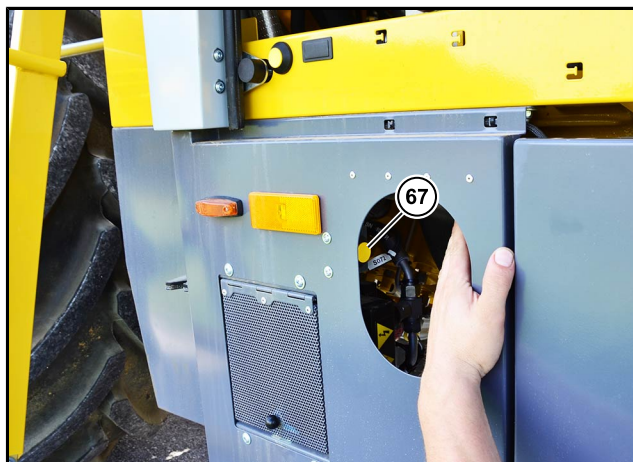
(67) Przełącznik oświetlenia wejścia do kabiny na maszynie
