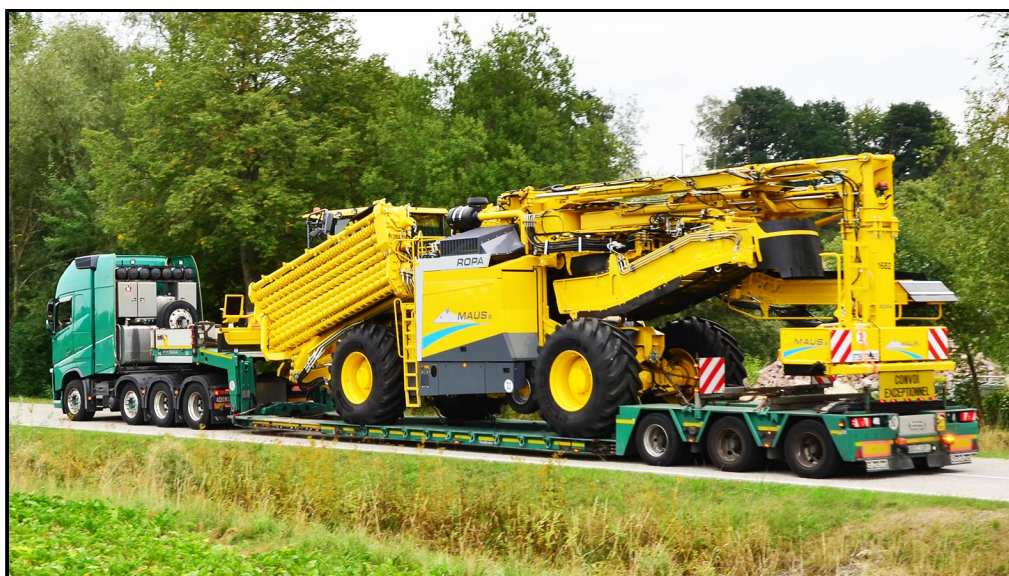
Prawidłowy pojazd niskopodłogowy do transportu drogowego o minimalnej wysokości transportowej
