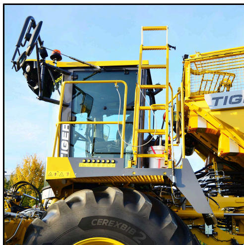
Drabinka wejściowa do kabiny kierowcy w pozycji jazdy drogowej lub w trybie wyorywania
