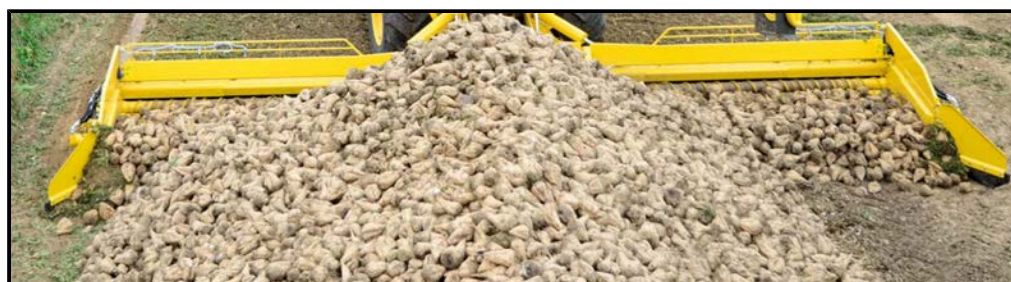
Impostazione errata delle paratie anteriori laterali. Accumulo di terreno intorno alle paratie anteriori laterali. Accostamento errato al cumulo. Ci si dovrebbe accostare il più centralmente possibile. (Immagine del modello precedente Maus 5)
