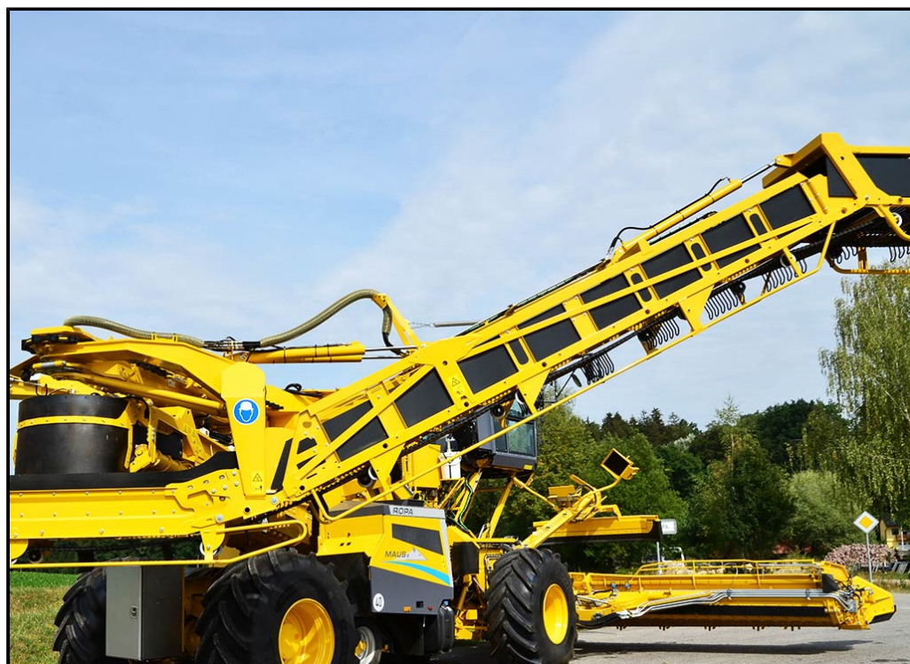
Nastro di scarico correttamente teso
