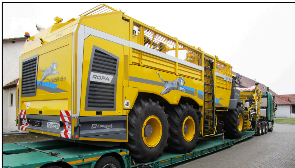
Správný podvalník k přepravě po silnici s minimální přepravní výškou
