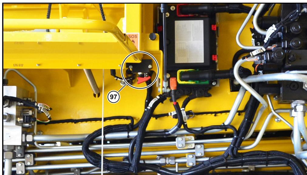
Napájení na nouzovém vypínači zapnuto ("Nouzové odpojení baterie")
