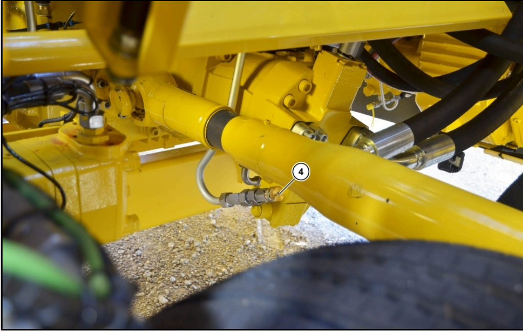
(4) صمام ملء الزيت الهيدروليكي مع الالات ذات محرك القيادة (حتى 32 كم/سا)، على محرك وحدة دفع القيادة
