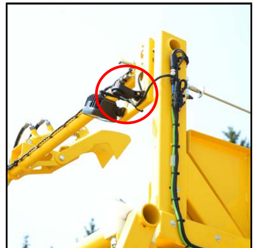
Digitale camera bunkeruitvoer
