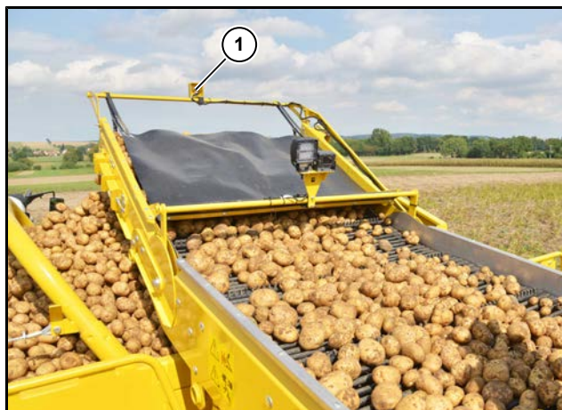
(1) Ultrasoonsensor automatisch vulmechanisme
