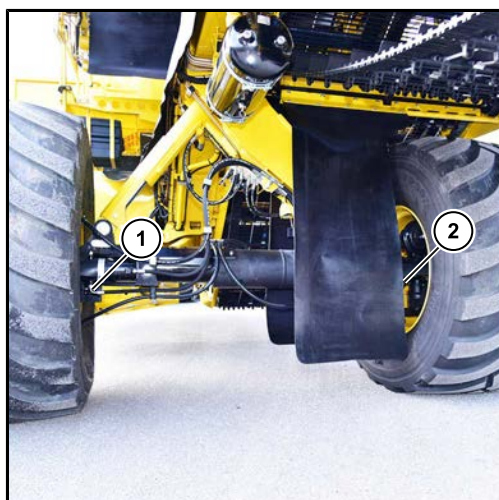
(1) Capteur direction de l'essieu à gauche
