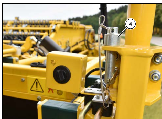
(4) Boulon de blocage toit de protection arrière gauche position de stationnement
