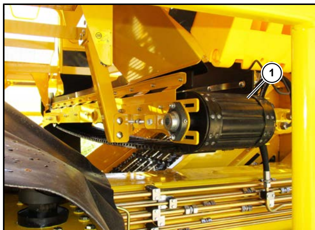
(1) Tapis d'évacuation des déchets
