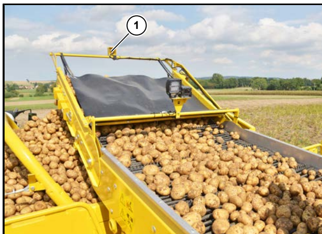
(1) Capteur à ultrason automatique de remplissage
