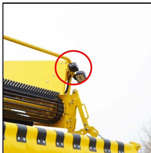
Caméra vidéo de la sortie du tapis de déchargement
