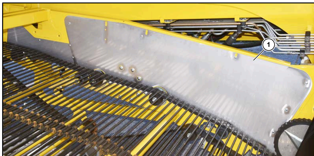
(1) Tôle en acier inoxydable à gauche dans le canal de tamisage
