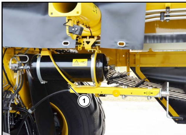
(1) Trykluftbeholder med aftapningsventil
