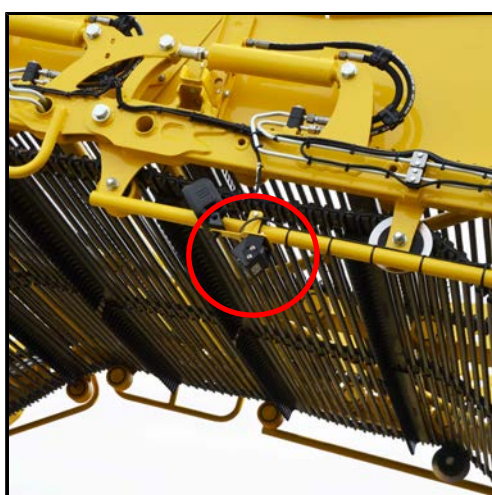
Kamera na odebíracím pásu, stroj s překládacím zásobníkem
