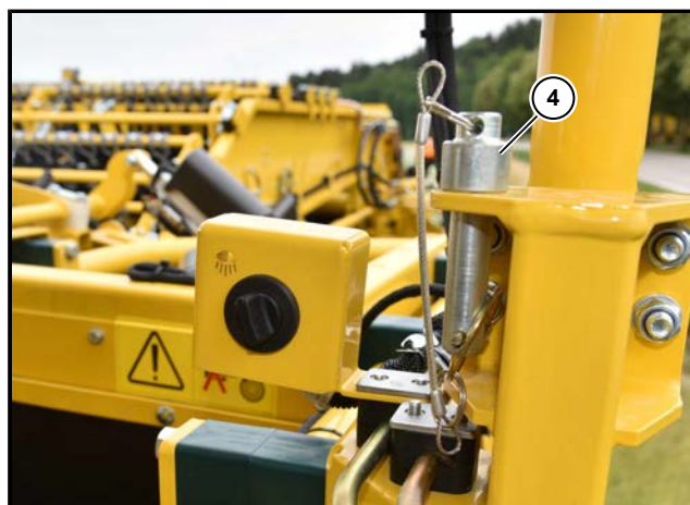
(4) Pojistný čep - ochranná stříška vzadu vlevo - parkovací poloha
