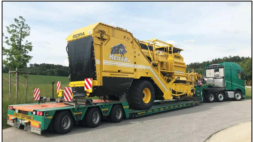
Správný podvalník k přepravě po silnici s minimální přepravní výškou
