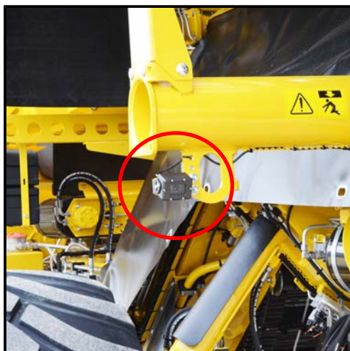
Kamera na vynášecím pásu nečistot
