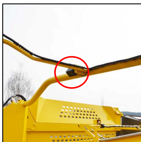
Kamera, vodící hřídel, stroj s překládacím zásobníkem
