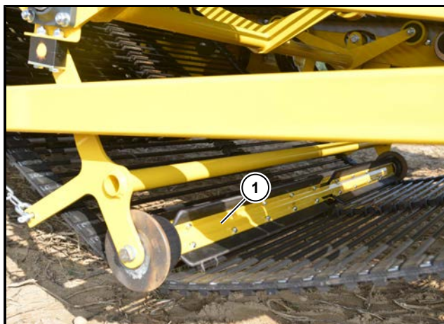
(1) Čistící válec, prosévací pás 1, r. v. 2016 až r. v. 2020
