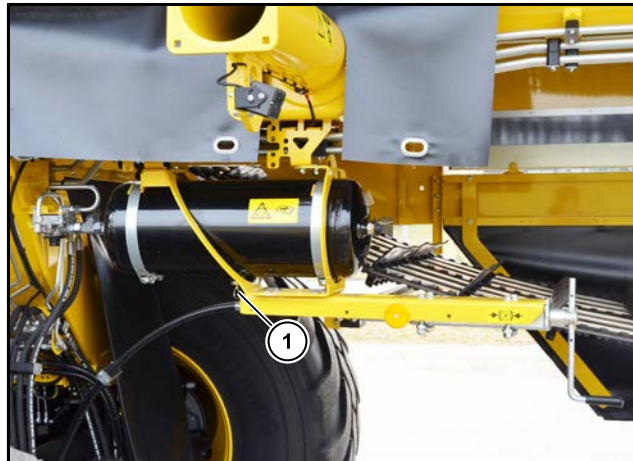
(1) Vypouštěcí ventil / ventil vypouštění vody
