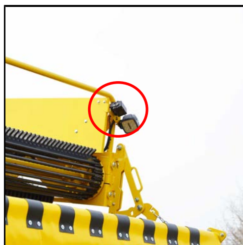
Kamera u výpusti, stroj s překládacím zásobníkem
