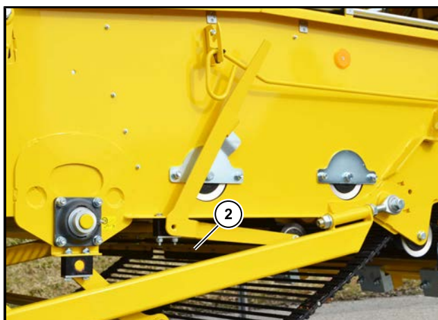
(2) Čistící válec, prosévací pás 1 vyvěšený, od r. v. 2021
