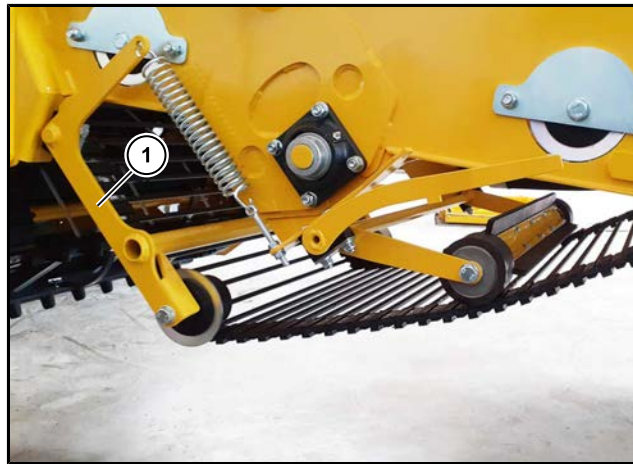
(1) Dispozitiv de tensionare transportor de cernere cu lanț 1
