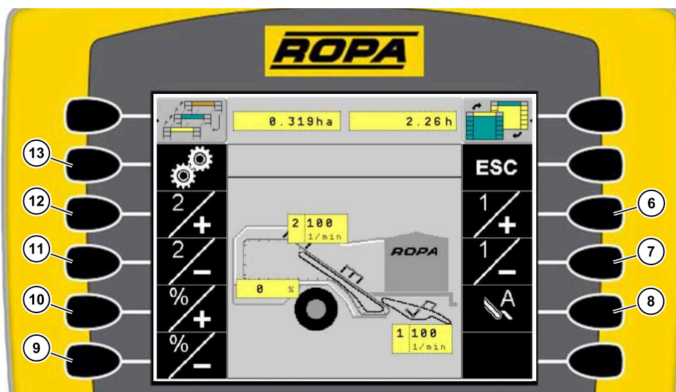
Automatyka taśm sitowych dezaktywowana przy pojedynczej regulacji
