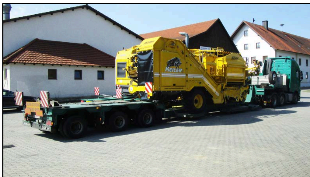
Normale dieplader voor transport via de openbare weg met minimale transporthoogte
