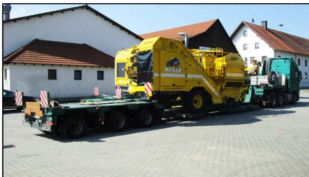
Remorque surbaissée en ordre pour le transport sur route avec une hauteur de transport minimale
