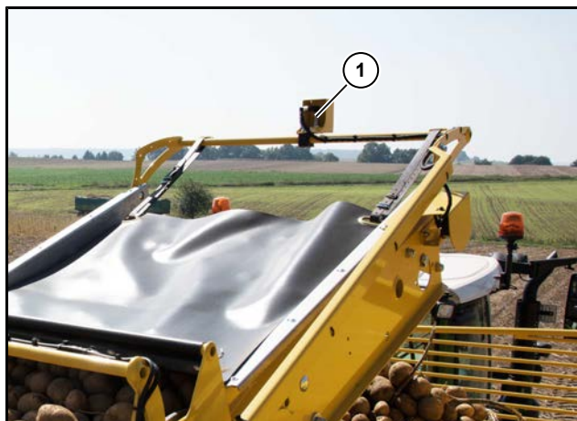
(1) Capteur à ultrason automatique de remplissage
