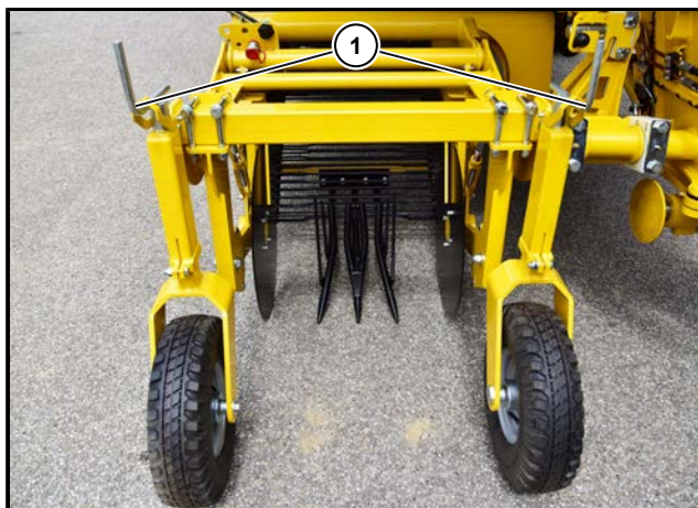
(1) Højdejustering af optager med gulerødder
