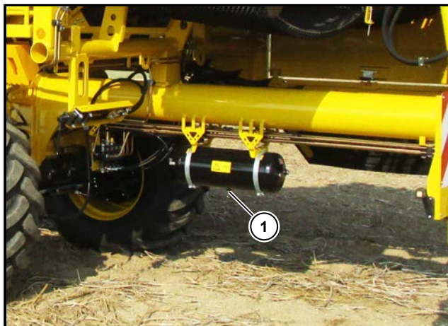
(1) Trykluftbeholder med aftapningsventil
