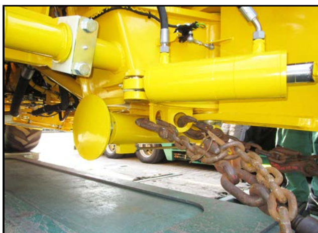
Fastsurringspunkter på støttebenet
