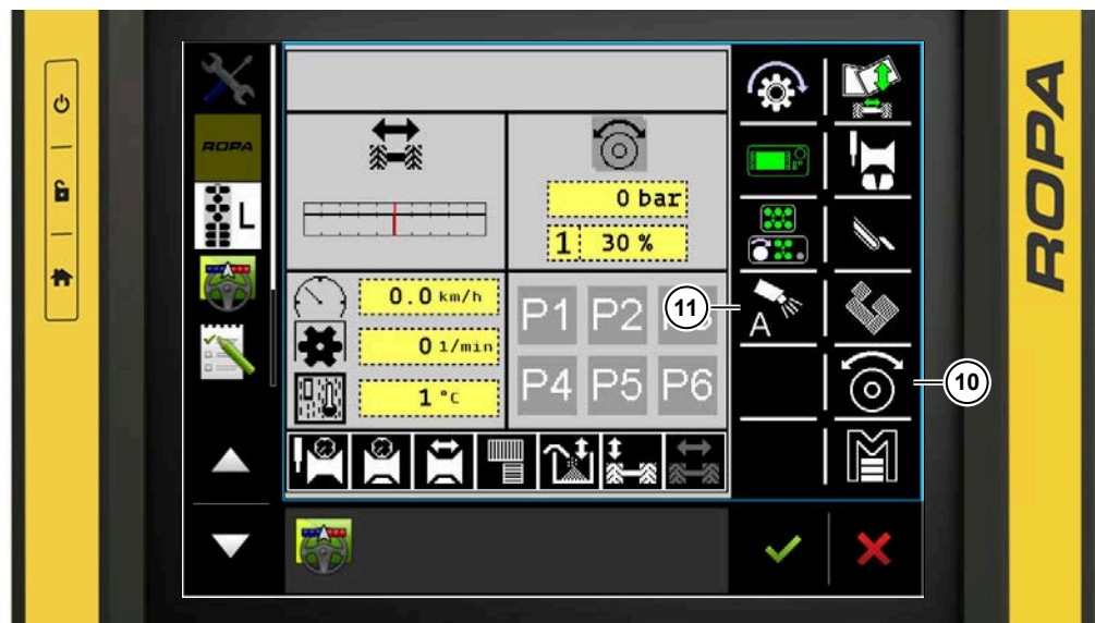
Menu Praca w terenie z opcjami koła napędowego i przełącznika wideo ROPA
