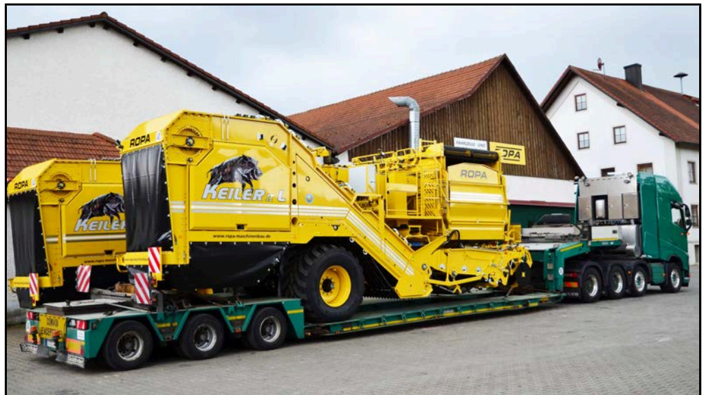
Prawidłowy pojazd niskopodłogowy do transportu drogowego o minimalnej wysokości transportowej
