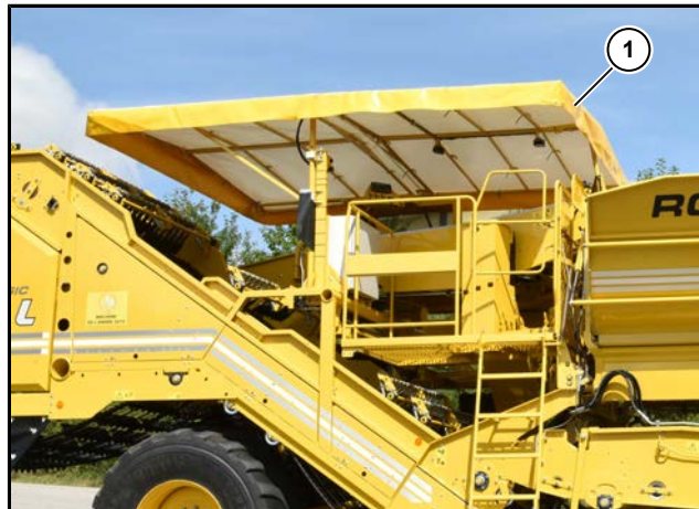
(1) Osłona przeciwsłoneczna w pozycji roboczej
