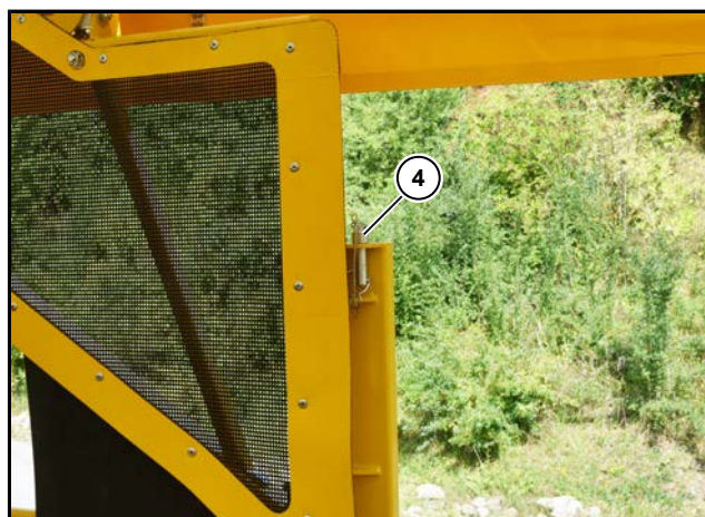
(4) Śruba zabezpieczająca Dach ochronny z lewej strony pozycja parkowania
