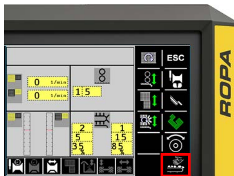
Klawisz funkcyjny stół selekcyjny z opcjonalnym kołem napędowym
