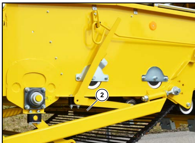
(2) Rensevalse rensbånd 1, hængtet af fra konstruktionsår 2021
