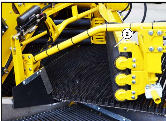
(2) Afledningsvalse 2 elektrisk justerbar
