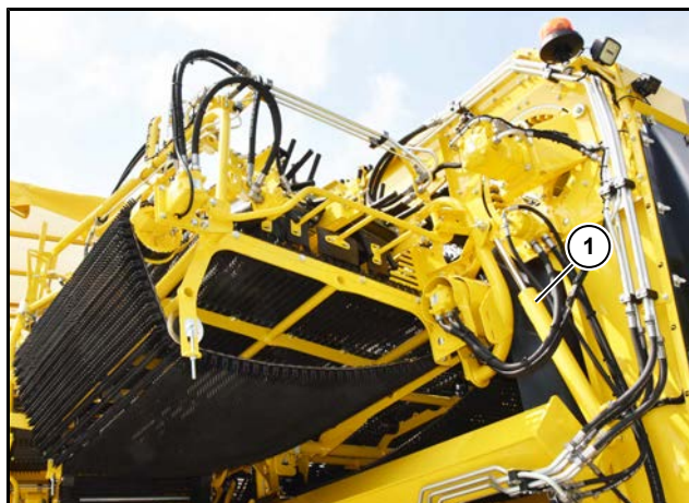
(1) Hydraulikcylinder pigbånd 1/2 hældning (ekstraudstyr)
