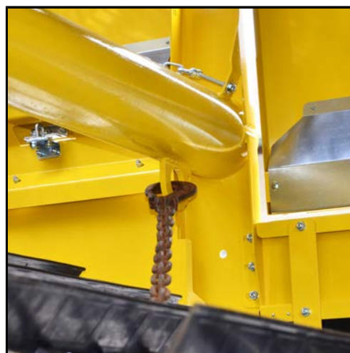
Fastsurringspunkt på maskinen i højre side
