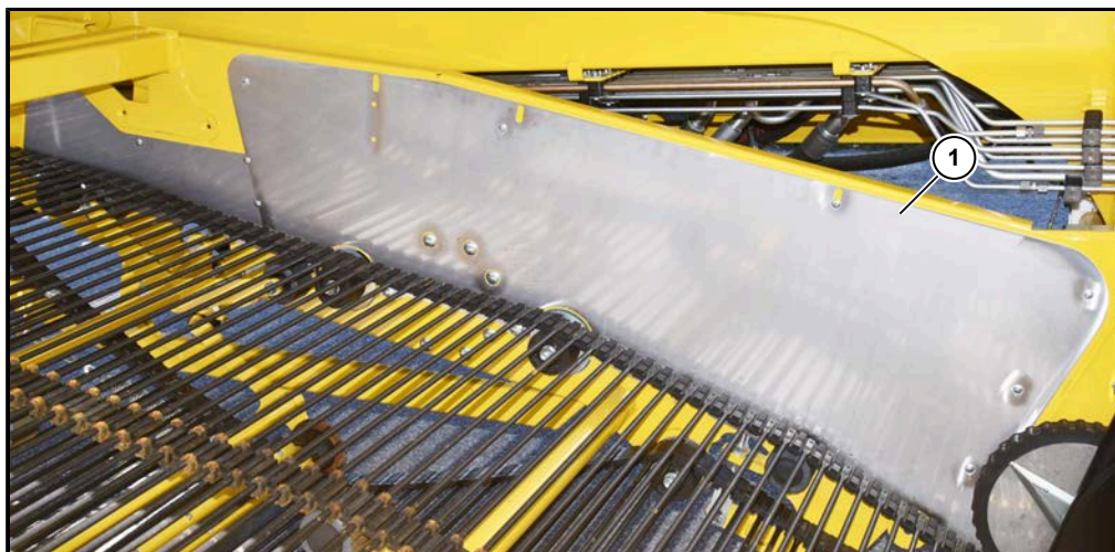
(1) Specialstålplade venstre i sigtekanal
