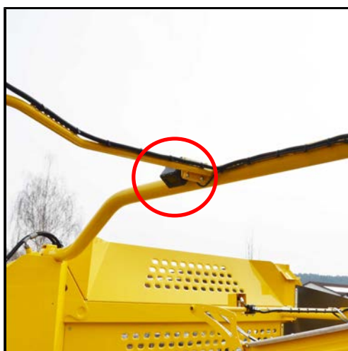
Videokamera overføringsaksel aflæsser
