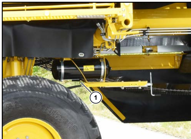
(1) Trykluftbeholder med aftapningsventil
