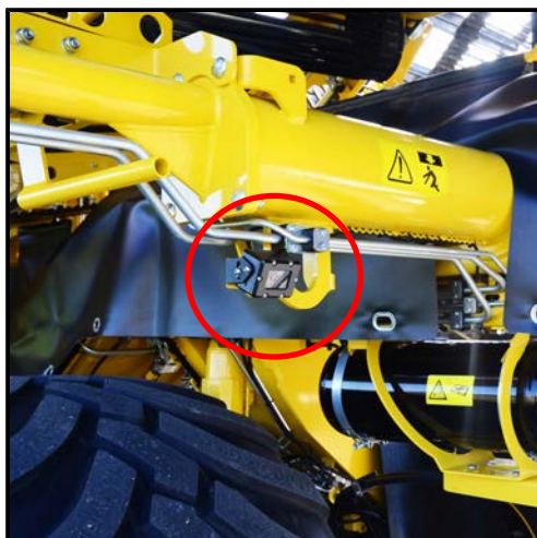
Cameră video bandă de evacuare a murdăriei
