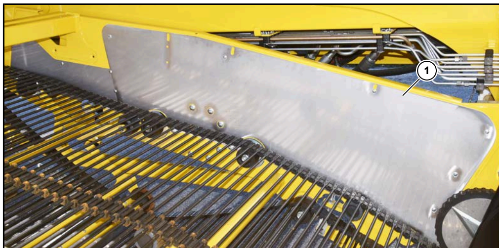
(1) Roestvrijstalen plaat links in zeefkanaal
