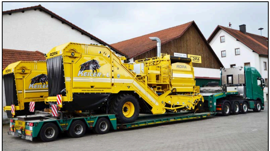
Normale dieplader voor transport via de openbare weg met minimale transporthoogte
