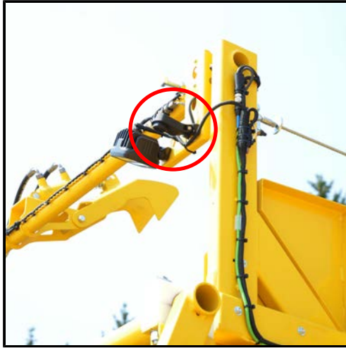
Digitale camera bunkeruitvoer
