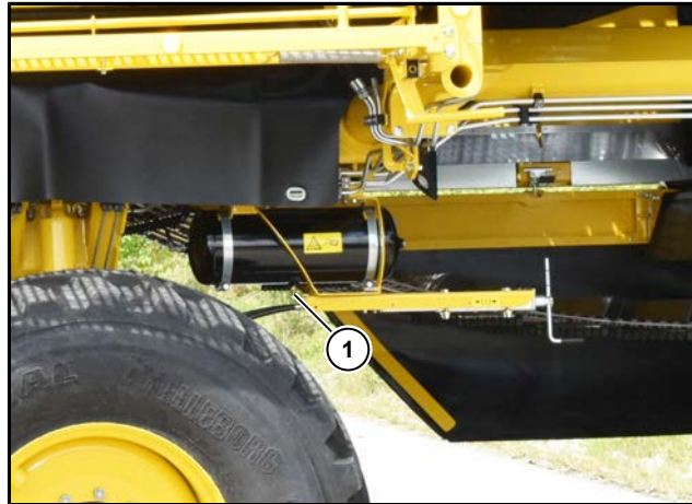
(1) Réservoir d'air comprimé avec soupape d'écoulement
