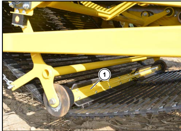
(1) Rouleau de nettoyage chaîne de tamisage 1 années de construction 2019 à 2020
