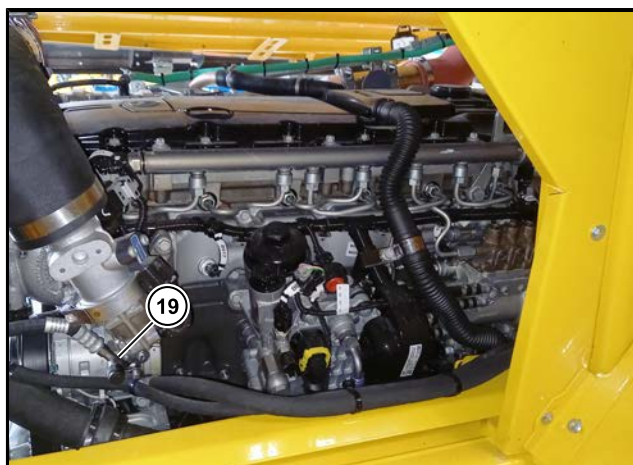
(19) Złącze serwisowe na kompresorze klimatyzacji
