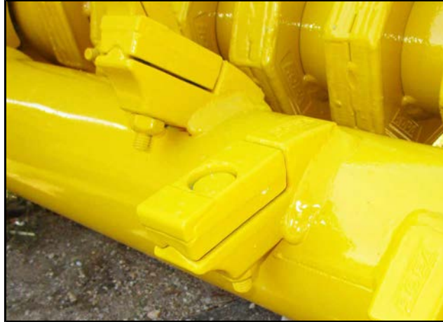
Palce podbieracza z płytkami zużywalnymi
