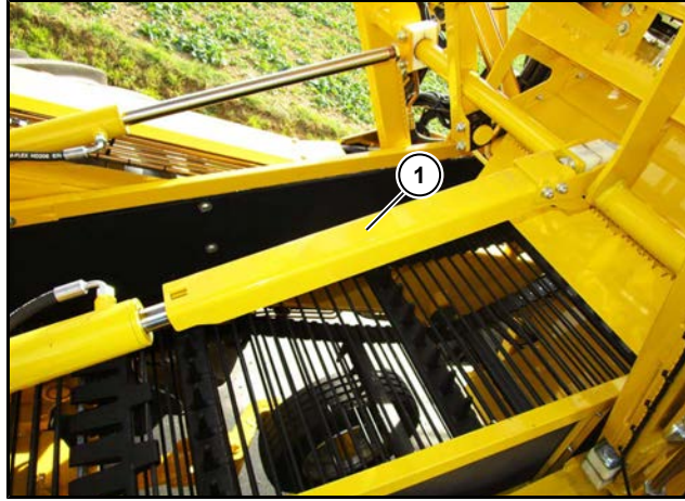
Podpora cylindryczna założona
