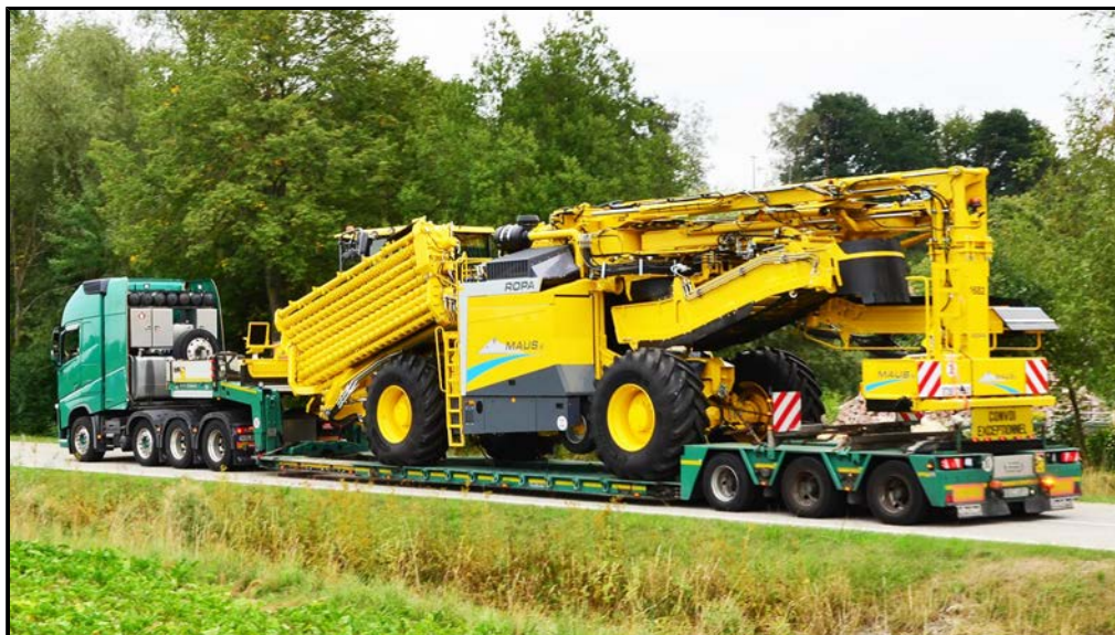
Elément surbaissé en ordre pour transport sur route avec une hauteur de transport réduite
