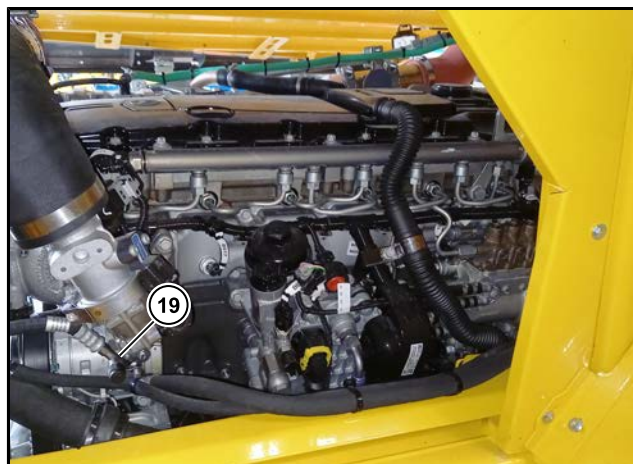
(19) Servicetilslutning på klimakompressor
