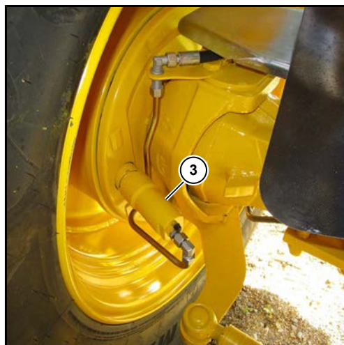
(3) Bagaksel med hydraulisk aktiveret tromlebremse
