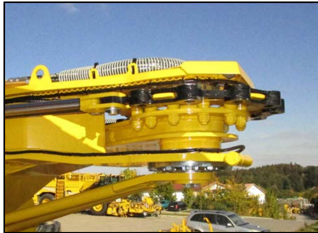
Drejning af kædedrev på aflæsser
