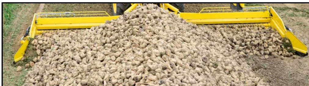
Forkert indstilling af rømmepladerne. Ansamling af jord i området ved rømmepladerne. Endvidere forkert kørsel ved roekulen. Man skal så vidt muligt køre imod roekulen midtfor. (billede af tidligere model Maus 5)
