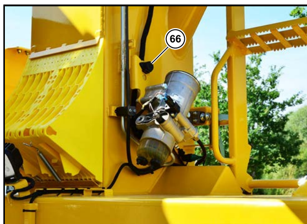
(66) Stikdåse på brændstoftank 24V/8A maks.
