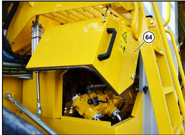
(64) Pumpeafdækning bag ved stigen
