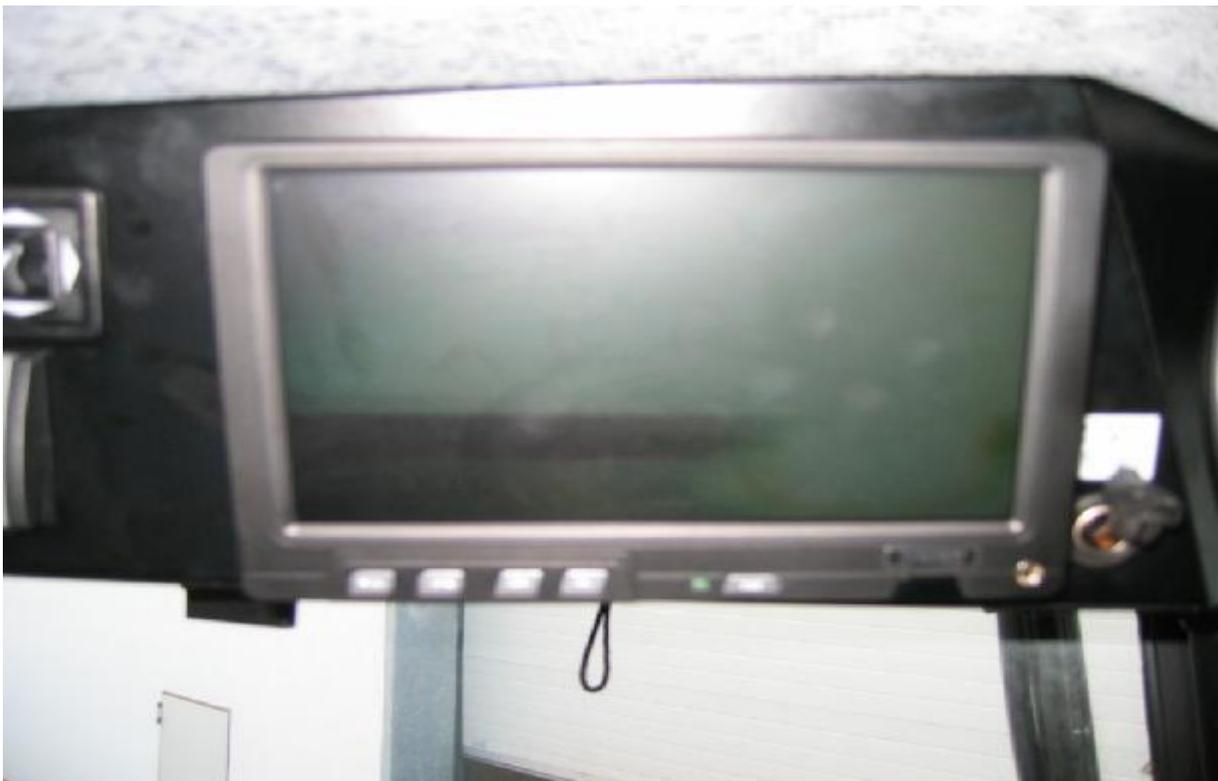
摄影机指示：按下控制台上标有摄影机标识的开关，可在最多三个摄影机的画面间进行切换。倒车时请选择倒车雷达的显示画面。
