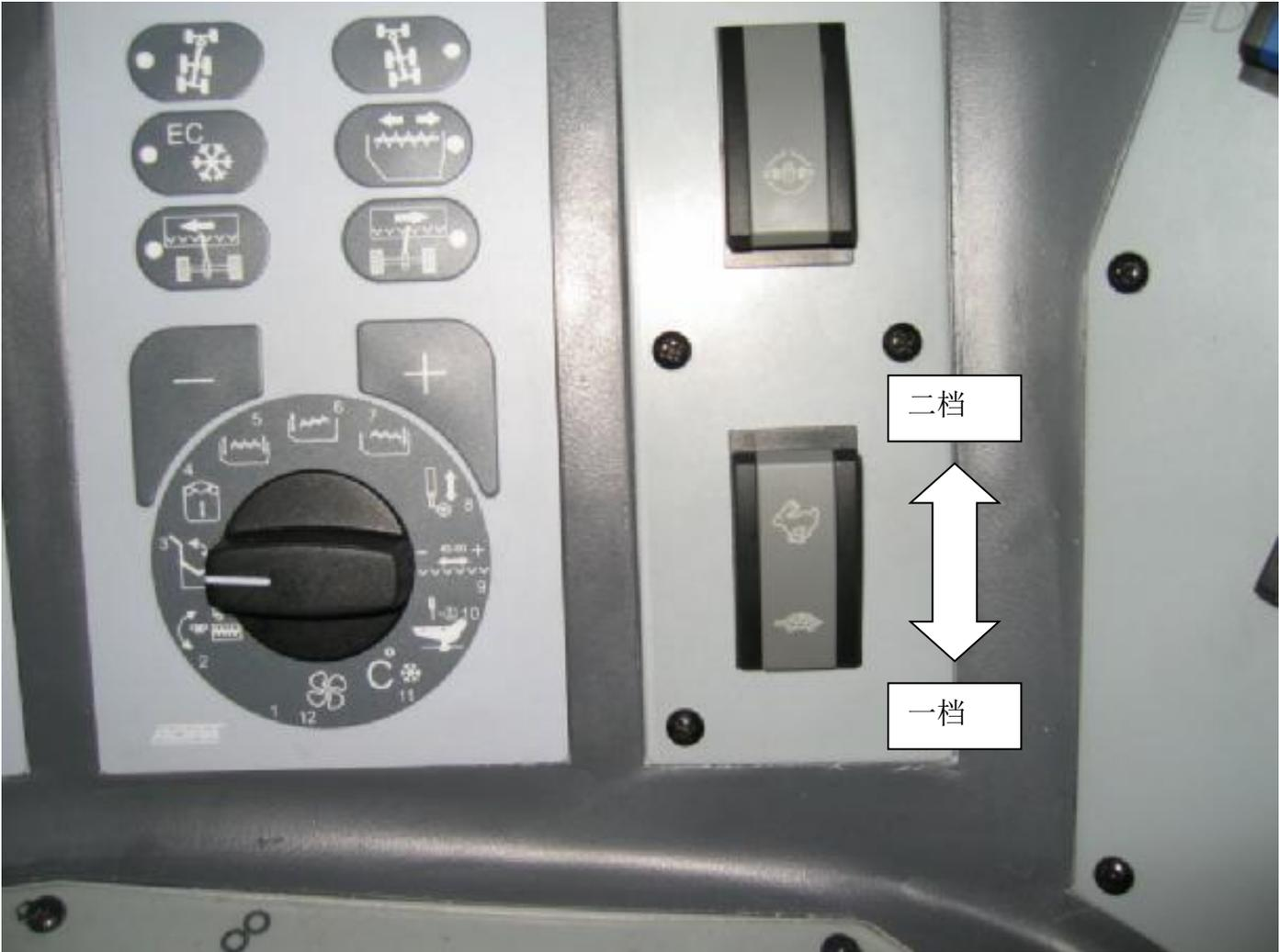
第四步：停车制动器的解除。若停车制动器未解除，您会同时在控制台的荧幕上看见警示标示并听见急促警示音。如果停车制动器未解除，则无法发动机器。
