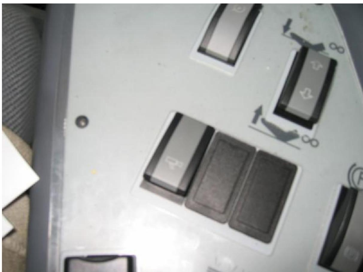
驾驶盘左侧的地面上有三个银色的按钮。在踩下油门的同时按下最右边的按钮即可倒车。 放开按钮则可前进。
