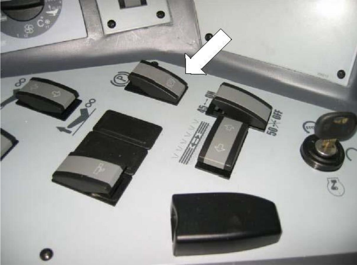
图中所示状况（表示P的一端按下时）是汽车制动器启动的状。
