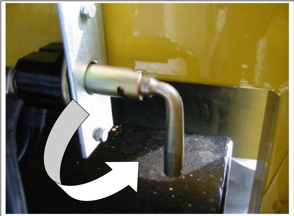
请您将电池主开关向下转至垂直（如图所示），既可切断电源。
