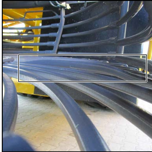
弯曲的星状过滤网弹齿
