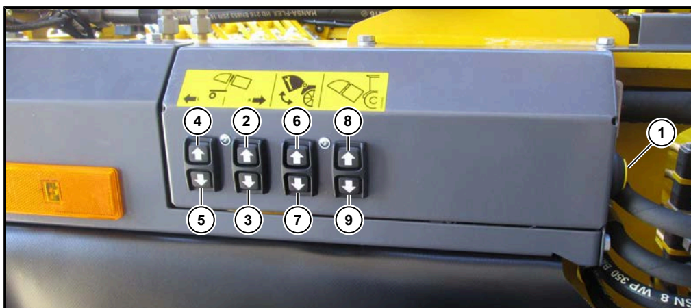
左侧犁头单元地面操作装置
