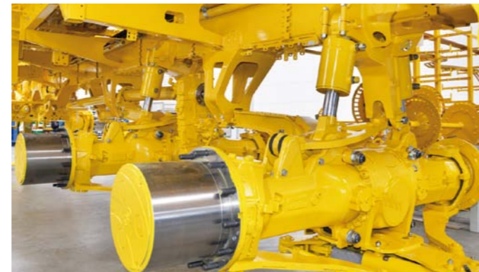
液压行走机构，自动斜坡平衡
