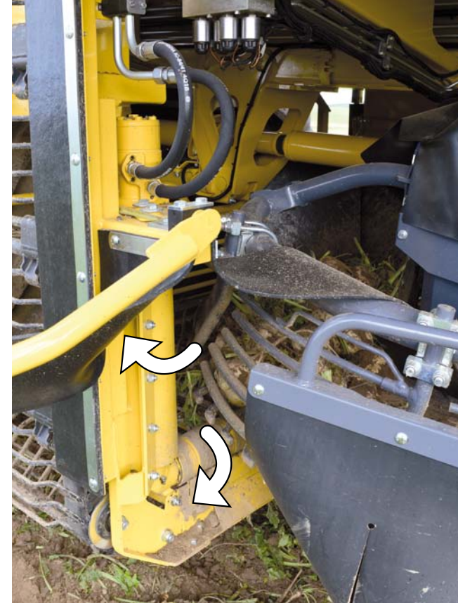
Drejende overgangsrør på elevatorindløbet forhindrer jordopbygning
