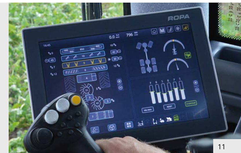
Automatisk justering af skår-dybden ved ujævn jordkontur Ultralydsensorer ved siden af hver roerække registrerer jordoverfladen
