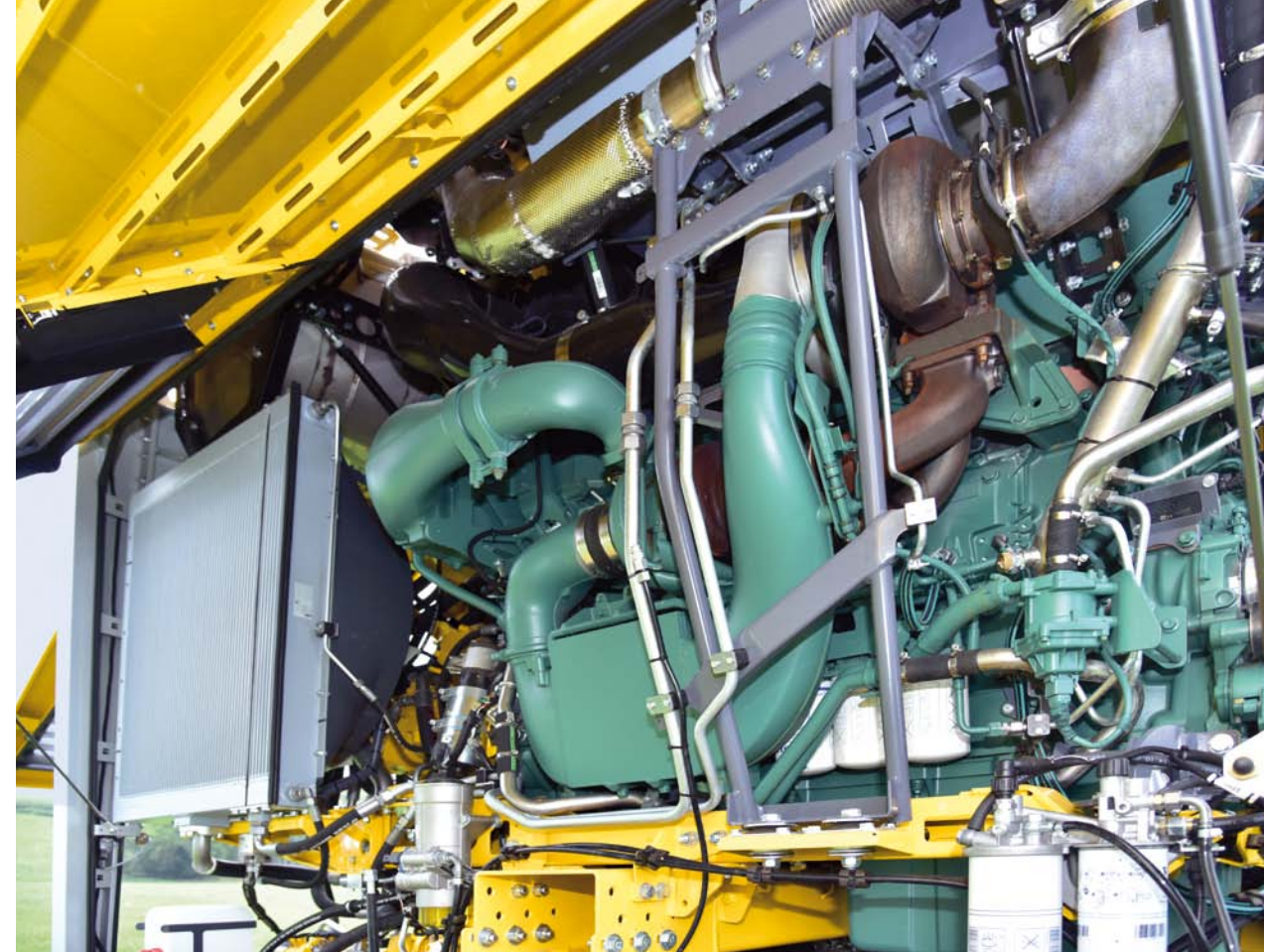
Volvo Penta TWD1683VE - basis for højere daglig ydelse ved mindre brændstofforbrug, endnu mere kraft ved lave omdrejningstal.
