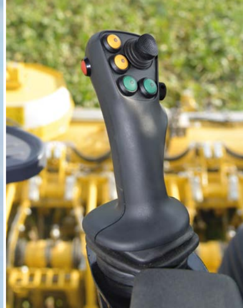
Betjenings-element på venstre armlæn til fintfølende styring af tanktømningen
