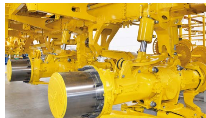
Hydraulisk akselsystem, automatisk hældningsudligning
